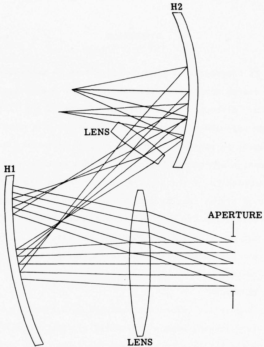
FIGURE 21. TWO LENS DESIGN SHOWING RAY BUNDLES AT FIELD ANGLES OF  $0^{\circ}$  AND  $+20^{\circ}$
