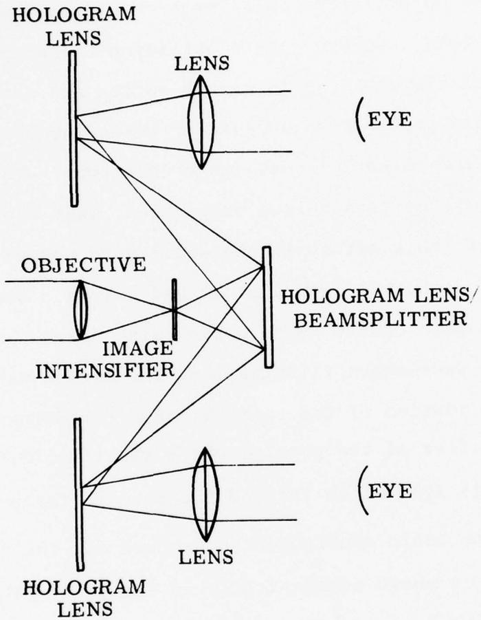
FIGURE 1. SCHEMATIC CONFIGURATION OF ONE-TUBE, TWO-EYE NIGHT GLASS WITH HOLOGRAPHIC OPTICAL ELEMENTS
