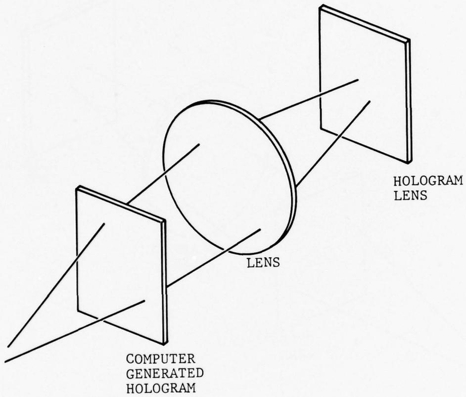
FIGURE 23. GENERATION OF ARBITRARY PHASE WAVEFRONT WITH HOLOGRAPHIC OPTICS
