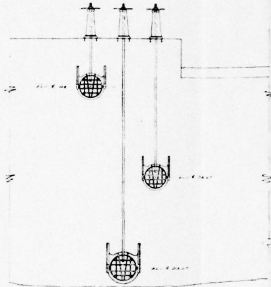
ELEVATION AT SLUICE GATES
