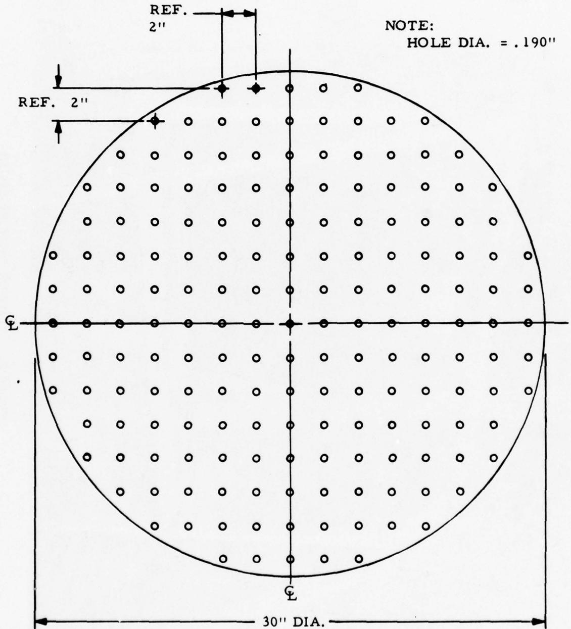
FIGURE 3. TRAVERSE EMISSION SAMPLE POINTS
