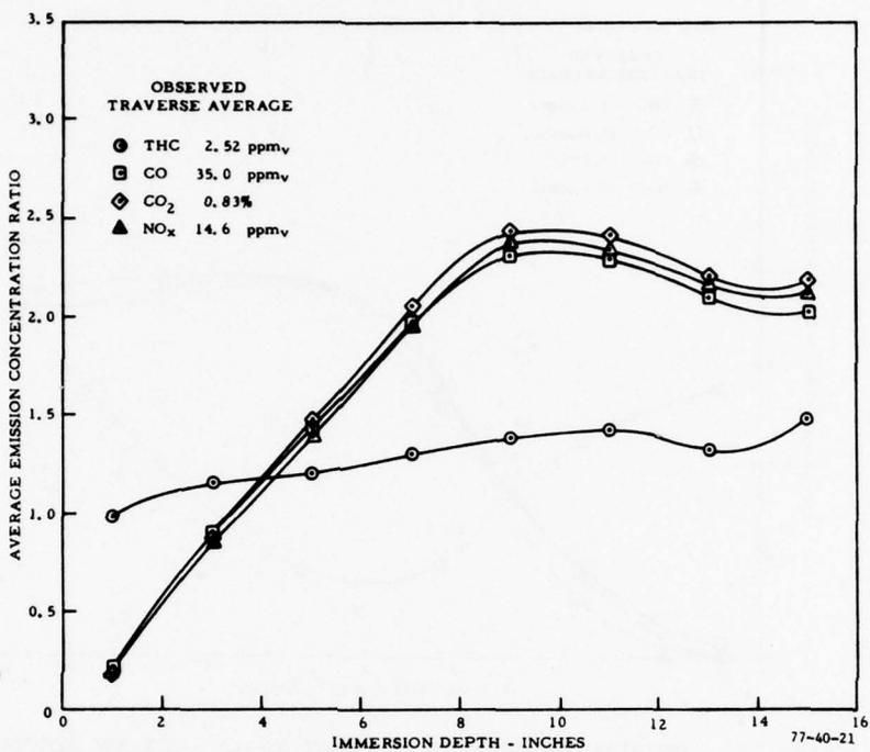
FIGURE 21. EMISSION CONCENTRATION DISTRIBUTION--90°--APPROACH POWER
