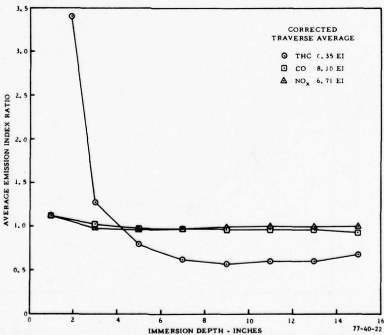
FIGURE 22. EMISSION INDEX DISTRIBUTION--90°--APPROACH POWER
