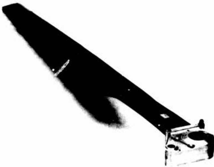
Fig. 4 BO 105 Fiberglass Rotorblade
