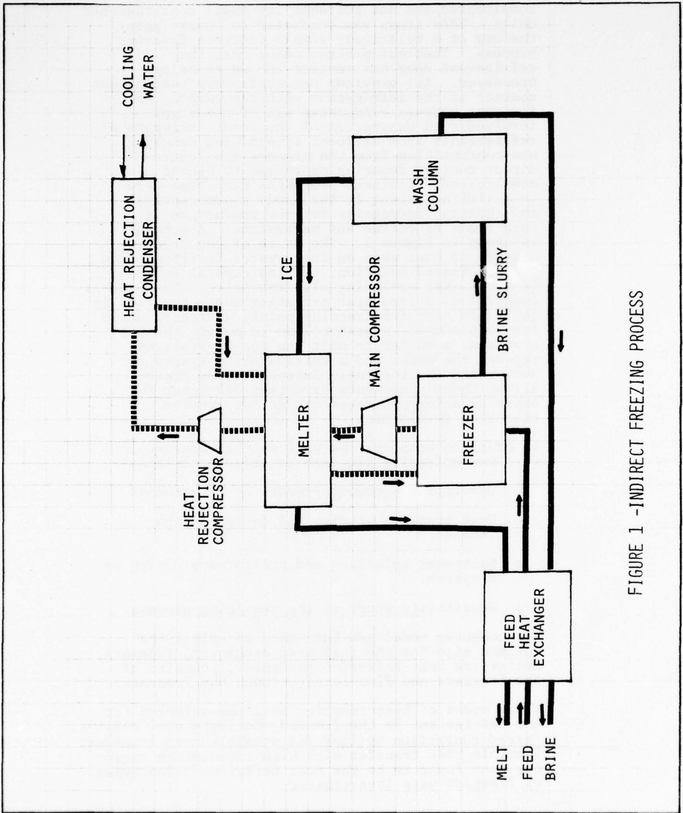
FIGURE 1 -INDIRECT FREEZING PROCESS
