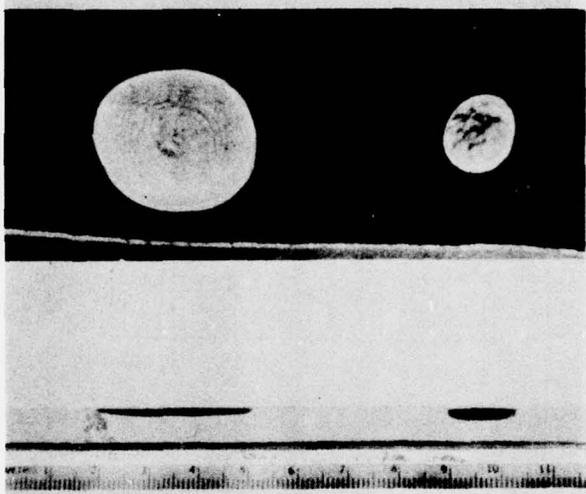
FIGURE 17 BEAM QUALITY OF LASER SYSTEM
