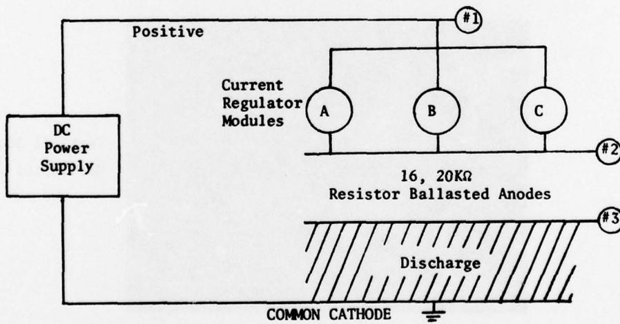
FIGURE 5 SCHEMATIC OF POWER SUPPLY DISTRIBUTION SYSTEM,
