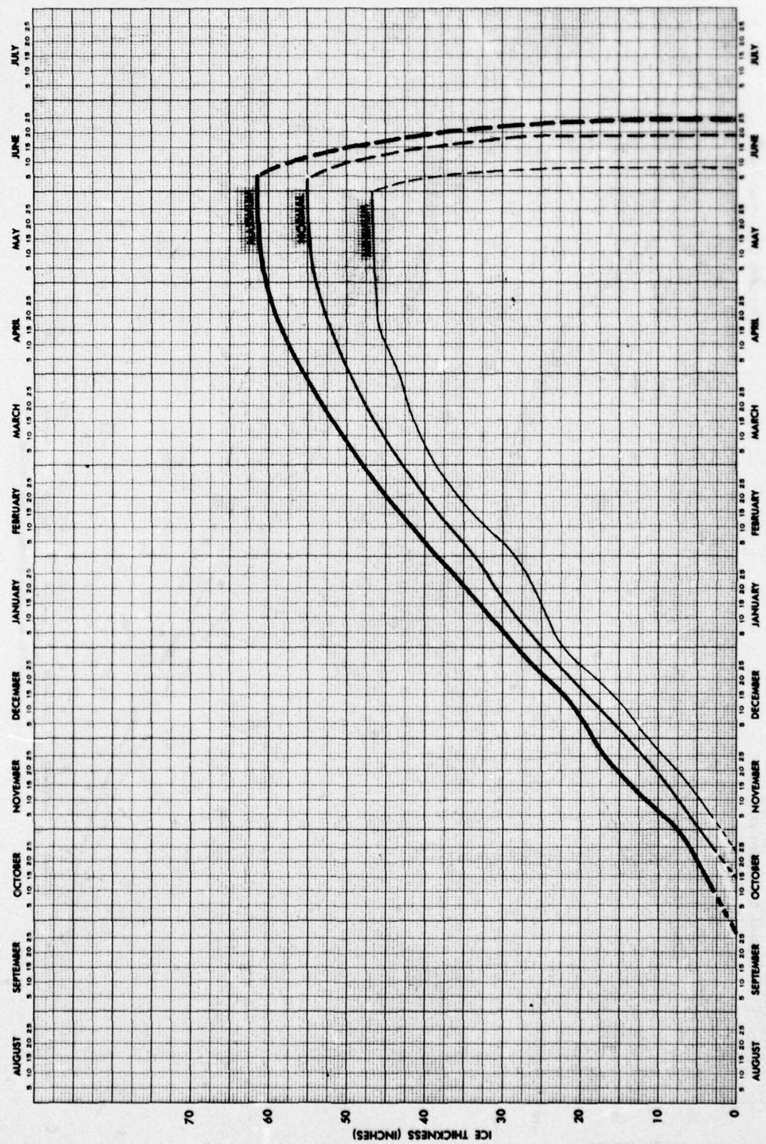
FIGURE 3B ATYS UELLEN THEORETICAL ICE GROWTH AND ESTIMATED DISINTEGRATION CURVES
