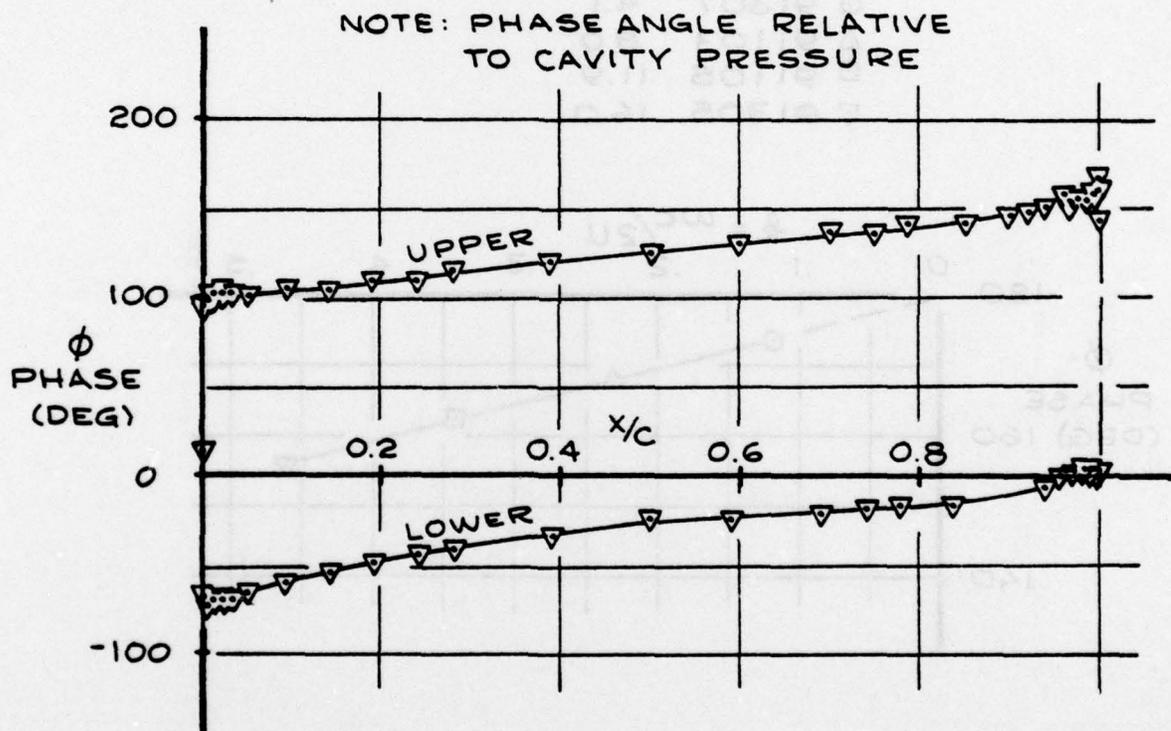
FIG. 3: AIRFOIL SURFACE PRESSURE PHASE ANGLES
