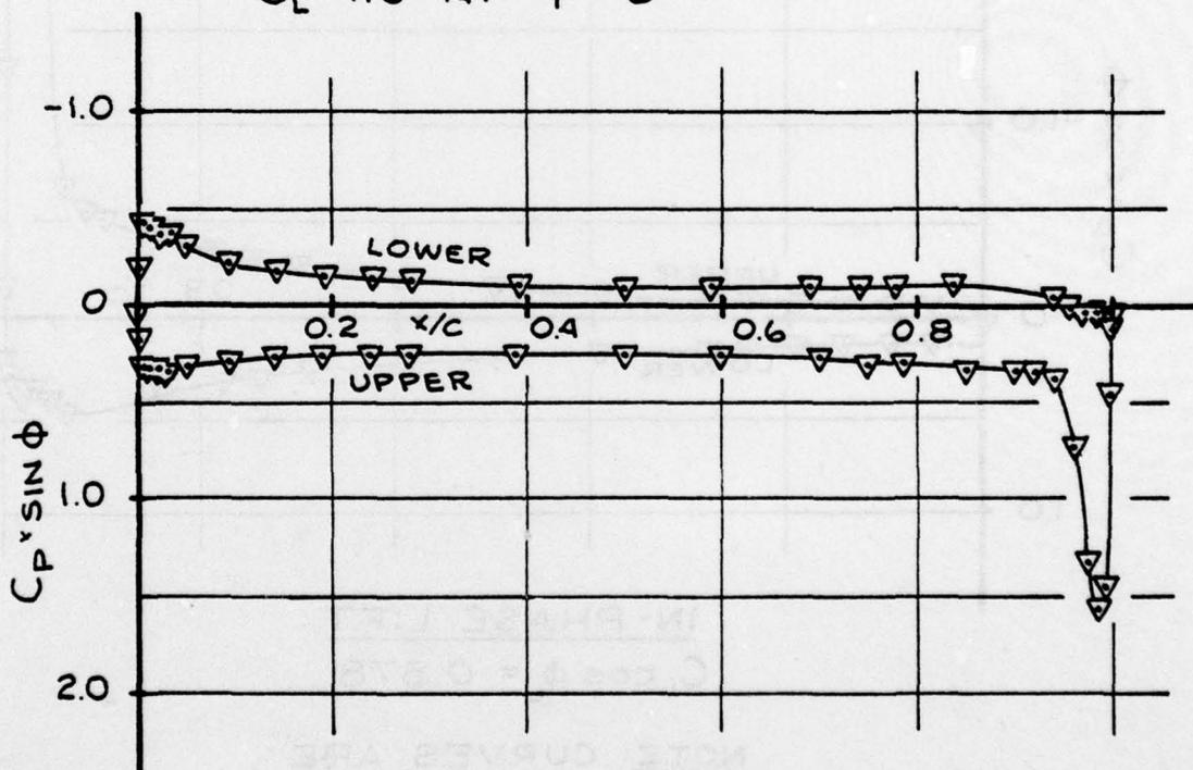
FIG.5: AIRFOIL OUT OF PHASE PRESSURE DISTRIBUTION
