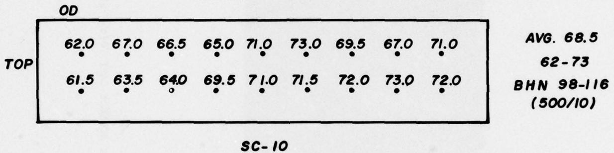
**FIGURE 11. HARDNESS PROFILES FOR SQUEEZE CAST 7075 ALLOY CYLINDERS**
