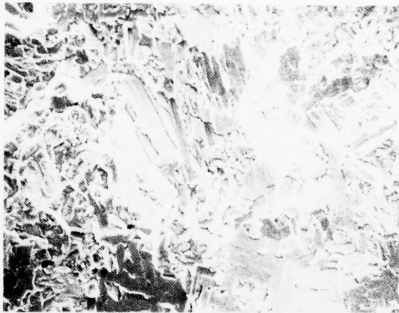
A. FRACTURE INITIATION SITE (400X MAG)
