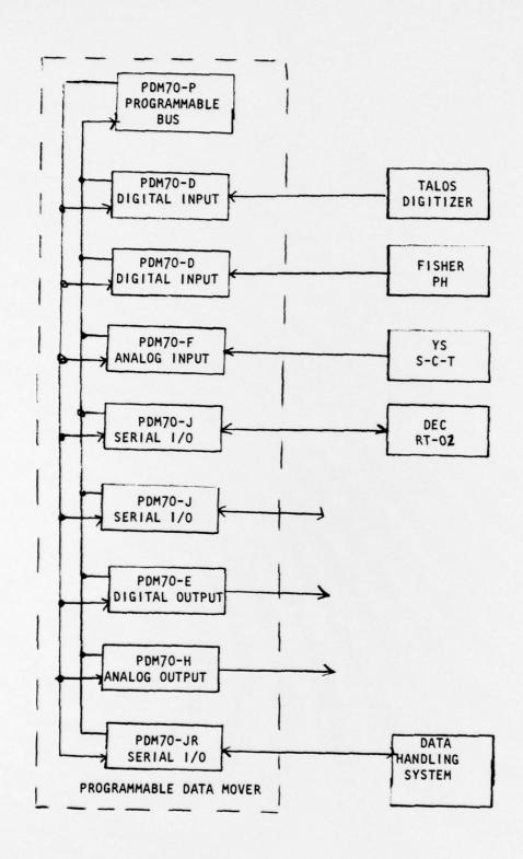
Figure 1 - BLOCK DIAGRAM OF THE AUTOMATED INSTRUMENTATION
