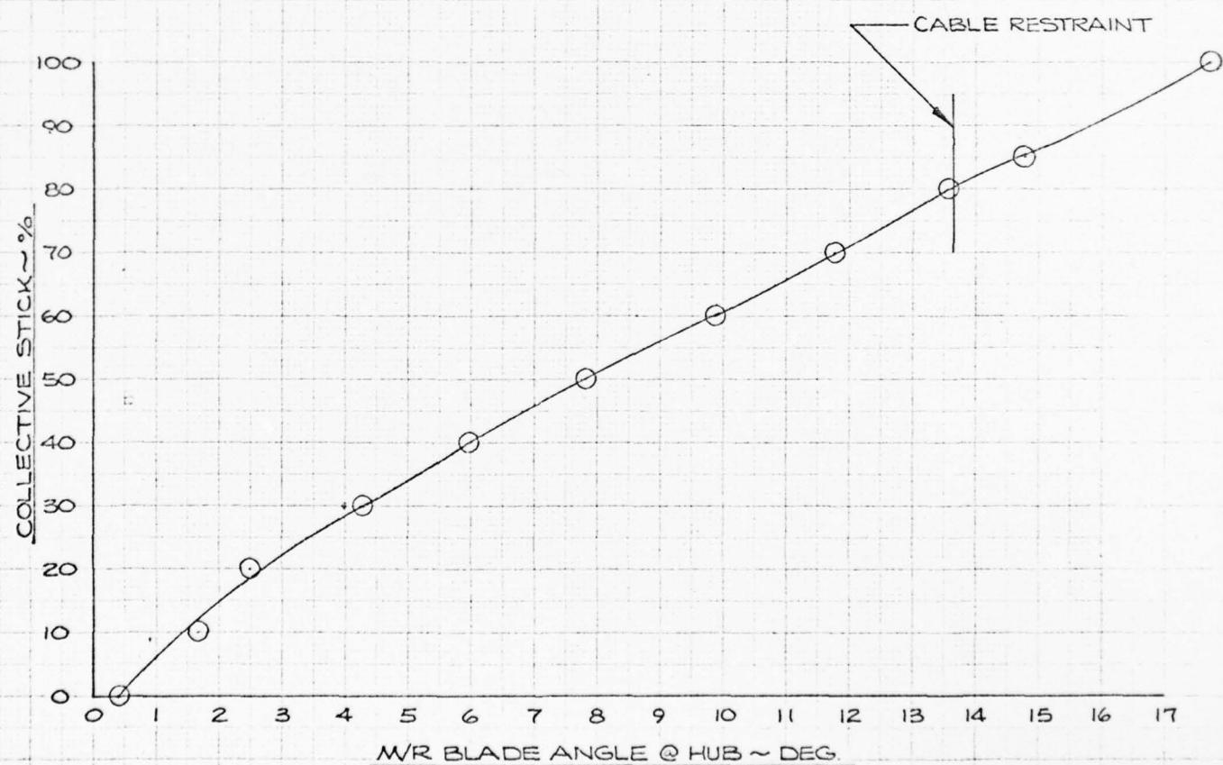
FIG 24 COLLECTIVE STICK POSITION VS M/R BLADE ANGLE
