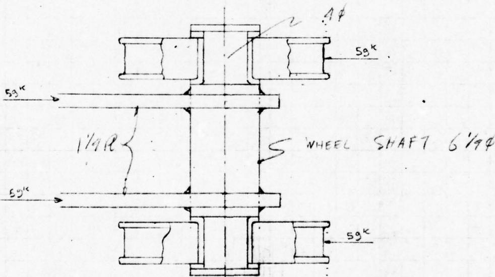
CENTER SHAFT WHEEL EQUALIZER Load  $118^k$ /BEAM
