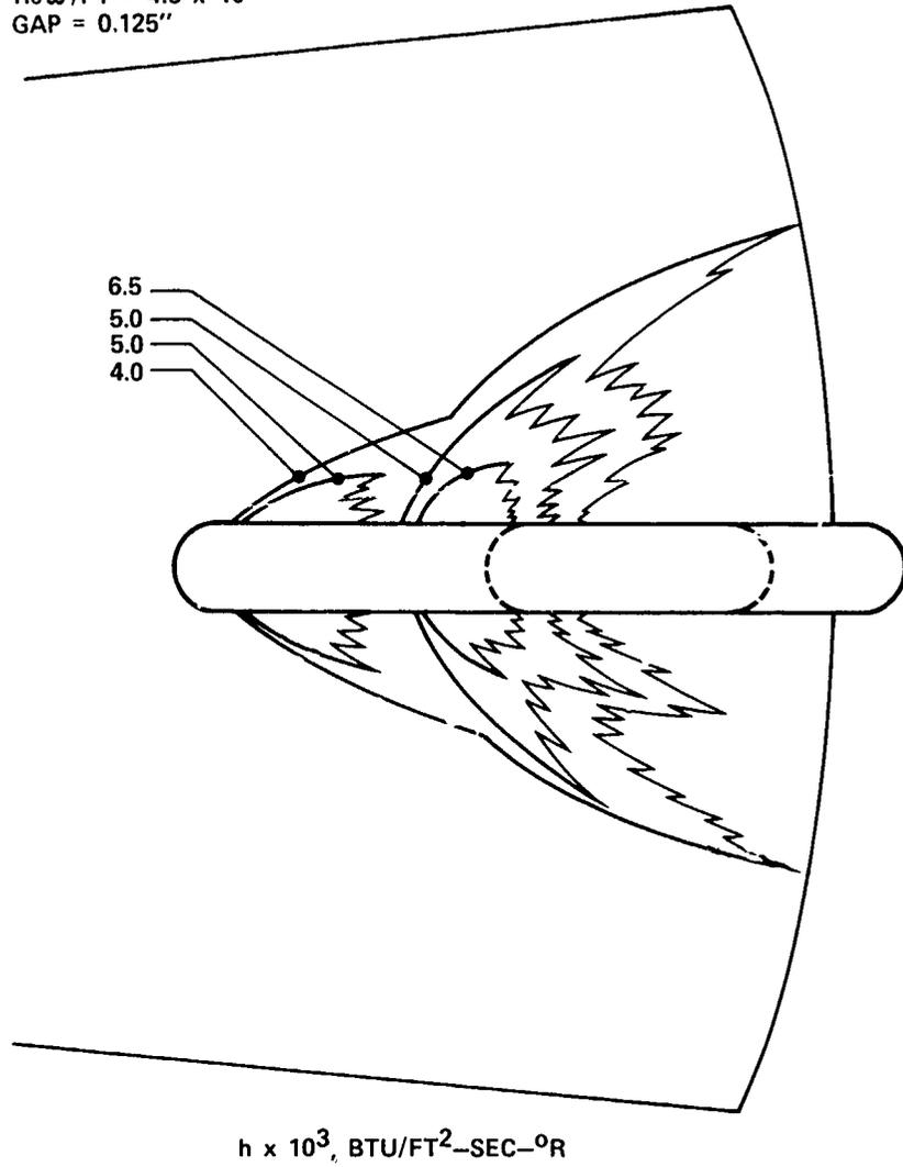
FIG. 38 ISOHEATING CONTOURS FOR 60° SWEEP FIN WITH 0.125-INCH FIN-CONE GAP. TOP VIEW
