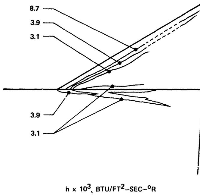
FIG. 21 ISOHEATING CONTOURS FOR FLUSH-MOUNTED 60° SWEEP FIN. SIDE VIEW.
