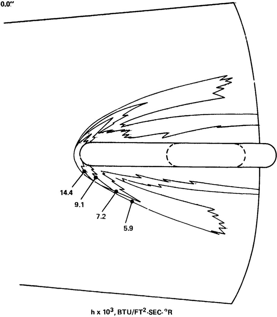
FIG. 23. ISOHEATING CONTOURS FOR FLUSH-MOUNTED 60°-SWEEP FIN. TOP VIEW
