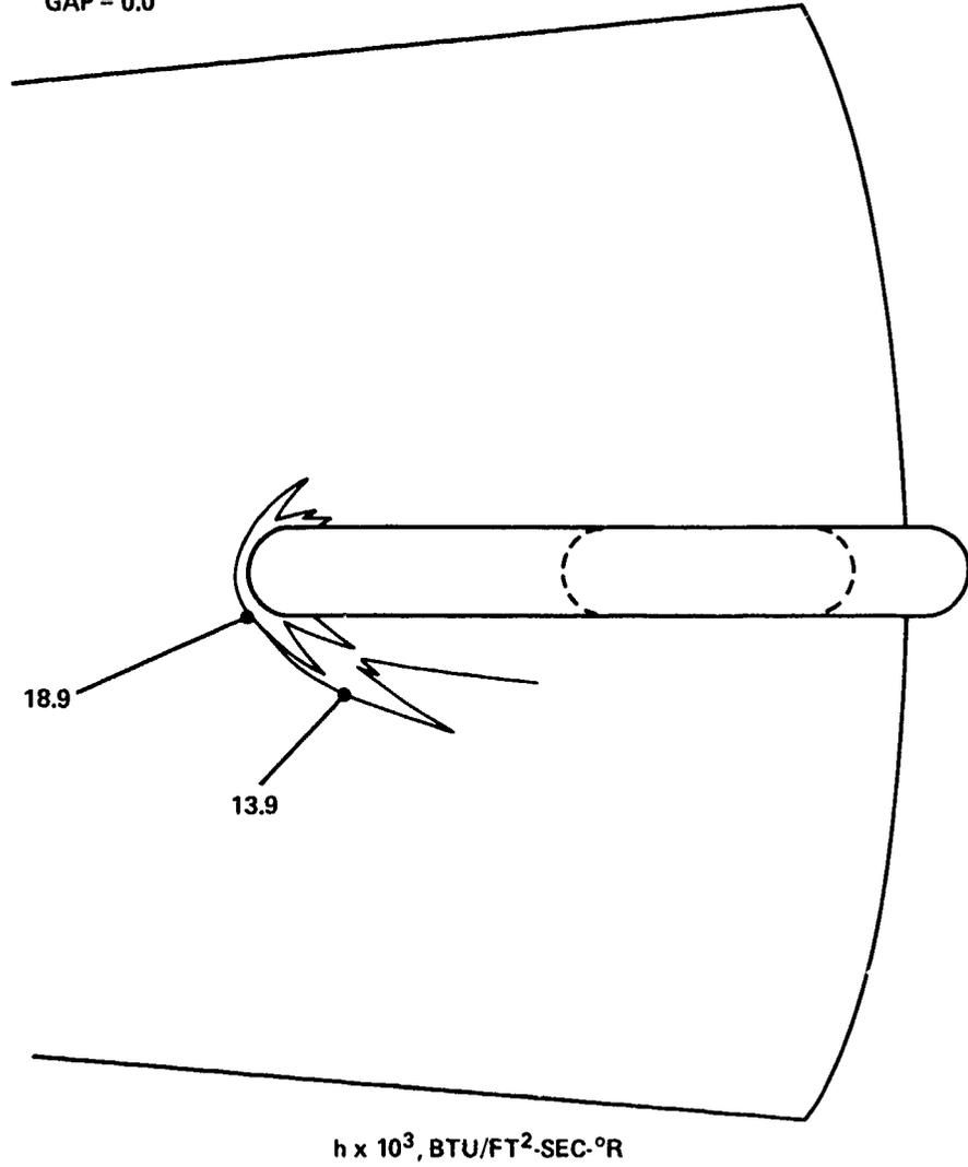
FIG. 24 ISOHEATING CONTOURS FOR FLUSH-MOUNTED 60°-SWEEP FIN. TOP VIEW
