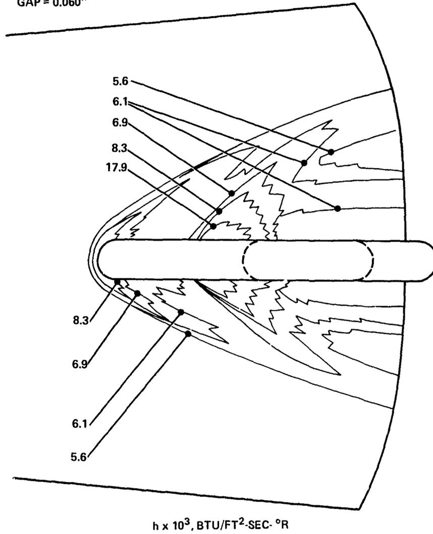
FIG. 31 ISOHEATING CONTOURS FOR 60°-SWEEP FIN WITH 0.060-INCH FIN-CONE GAP. TOP VIEW
