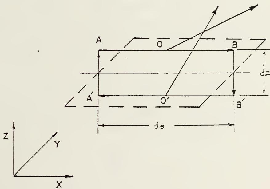
Fig. 3 Vortex Sheet Element
