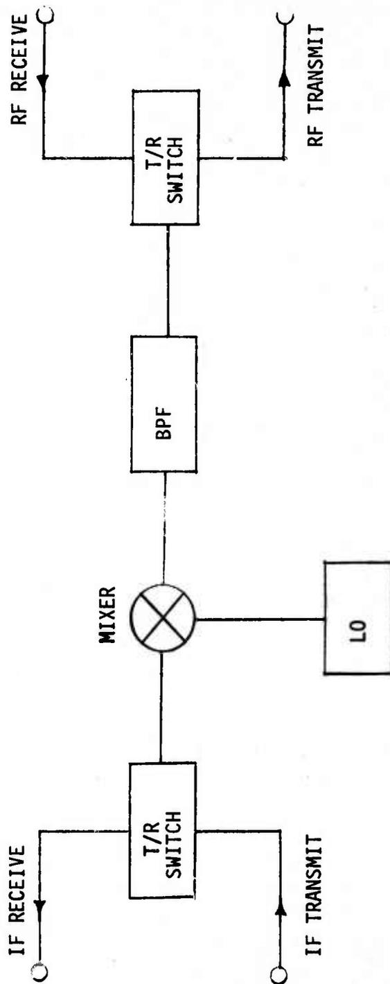
FIGURE 3.4.1 SINGLE MIXER SCHEME TO TRANSCIEIVER REALIZATION
