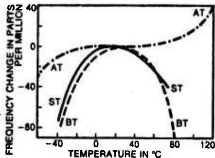
FIGURE 2.3.2 FREQUENCY-TEMPERATURE CHARACTERISTICS OF VARIOUS QUARTZ CRYSTAL RESONATORS
