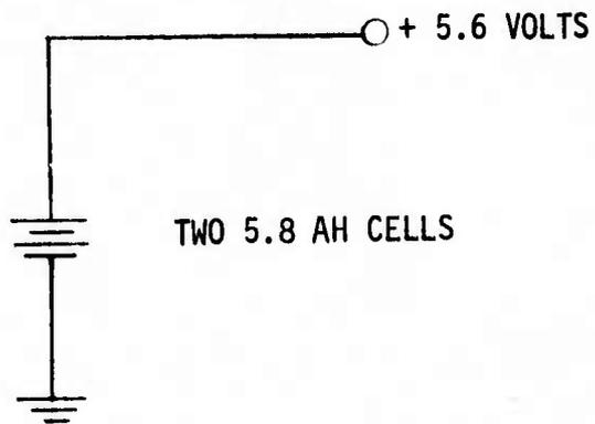
FIGURE 4.3.1 POWER SUPPLY SYSTEM USING LITHIUM CELLS
