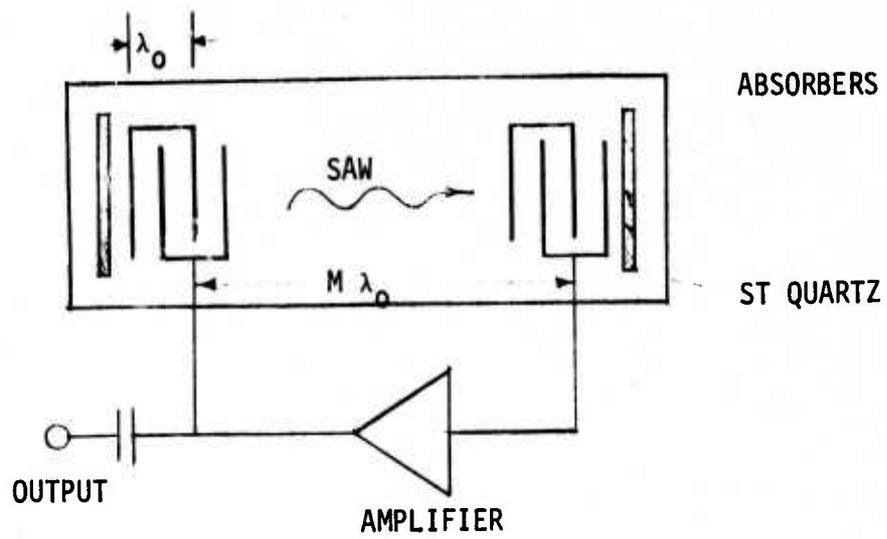
FIGURE 3.3.7 BASIC SURFACE ACOUSTIC WAVE OSCILLATOR STRUCTURE
