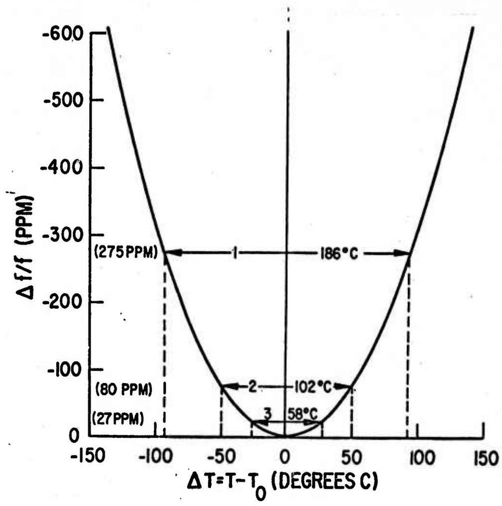
FIGURE 2.4.6 FREQUENCY VERSUS TEMPERATURE CHARACTERISTICS FOR ST QUARTZ
