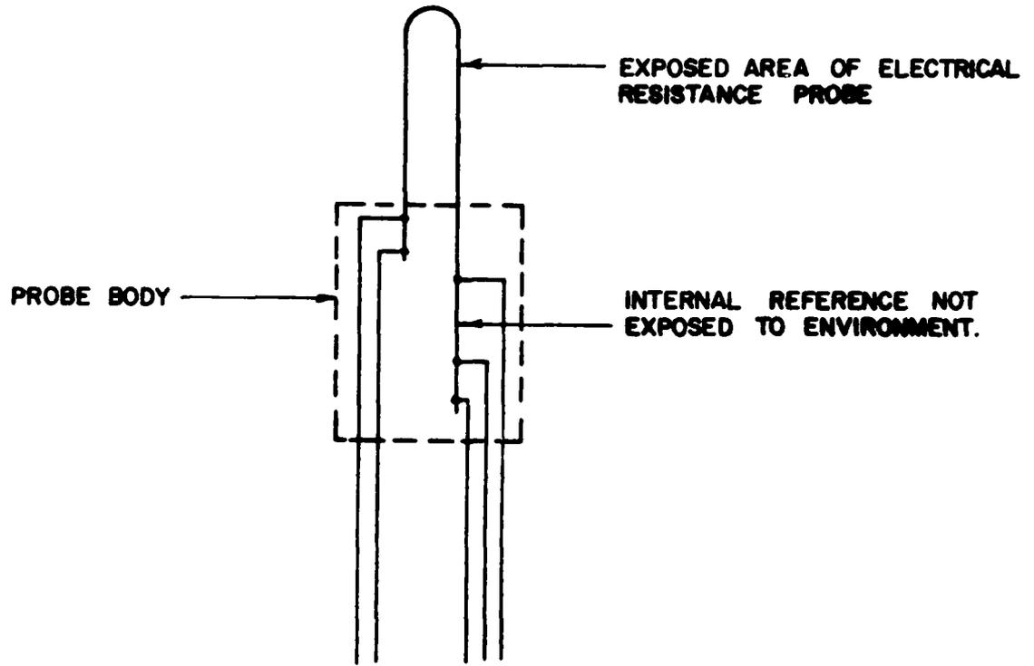
FIGURE B-1 - SCHEMATIC OF ELECTRICAL RESISTANCE CORROSION PROBE
