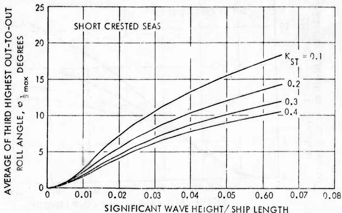
FIGURE 48 - MAXIMUM ROLL ANGLE AS A FUNCTION OF THE SIGNIFICANT WAVE HEIGHT TO SHIP LENGTH RATIO FOR VARIOUS ACTIVE TANK CAPACITIES; AUXILIARY TYPE SHIP AT  $V/\sqrt{L} = 0.8$
