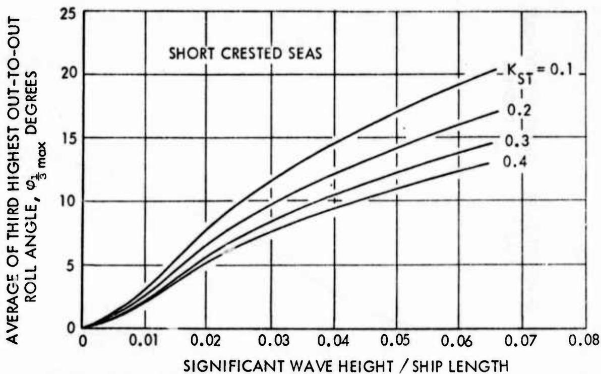
FIGURE 41 - MAXIMUM ROLL ANGLE AS A FUNCTION OF THE SIGNIFICANT WAVE HEIGHT TO SHIP LENGTH RATIO FOR VARIOUS PASSIVE TANK CAPACITIES; AUXILIARY TYPE SHIP AT  $V/\sqrt{L} = 0.8$
