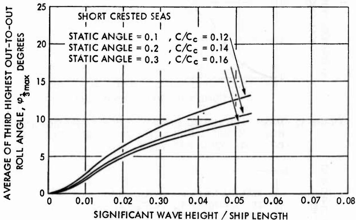
FIGURE 15 - MAXIMUM ROLL ANGLE AS A FUNCTION OF THE SIGNIFICANT WAVE HEIGHT TO SHIP LENGTH RATIO FOR VARIOUS ACTIVE FIN CAPACITIES; DESTROYER TYPE SHIP AT  $V/\sqrt{L} = 1.2$
