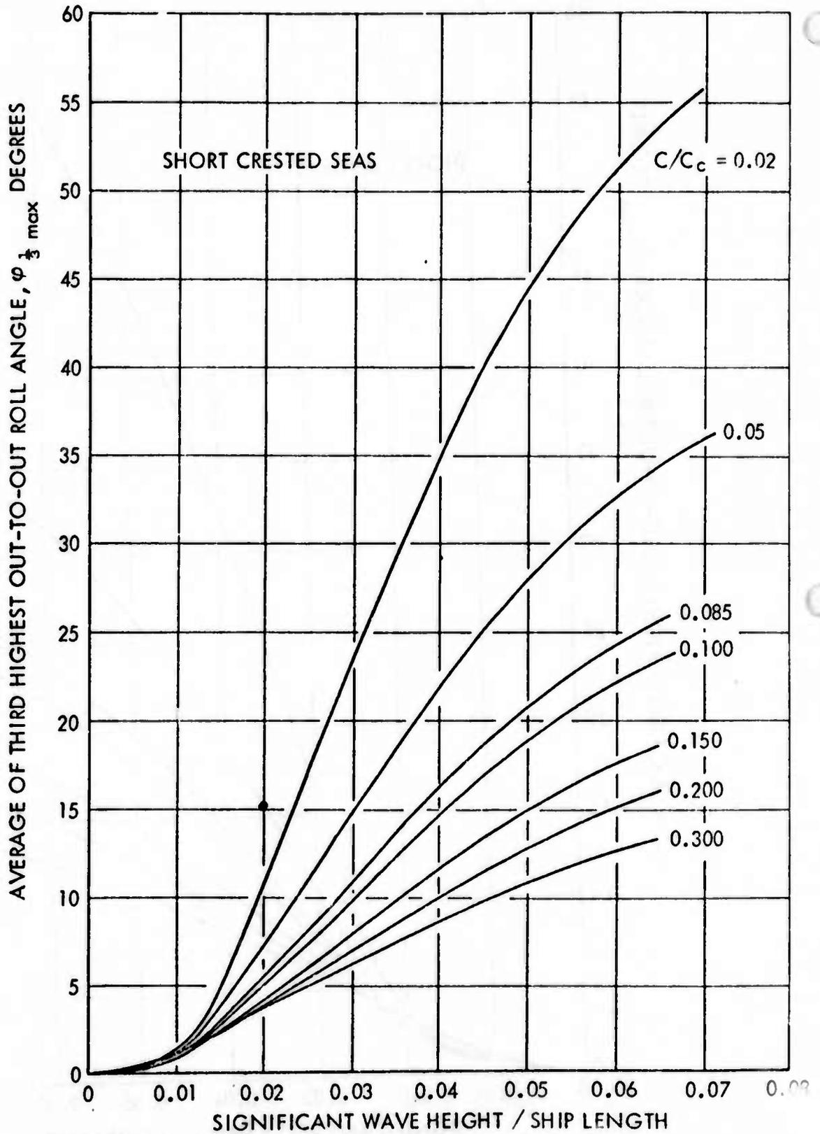
FIGURE 36 - MAXIMUM ROLL ANGLE AS A FUNCTION OF THE SIGNIFICANT WAVE HEIGHT TO SHIP LENGTH RATIO FOR VARIOUS SHIP DAMPING RATIOS; UNSTABILIZED AUXILIARY TYPE SHIP AT  $V/\sqrt{L} = 0.4$
