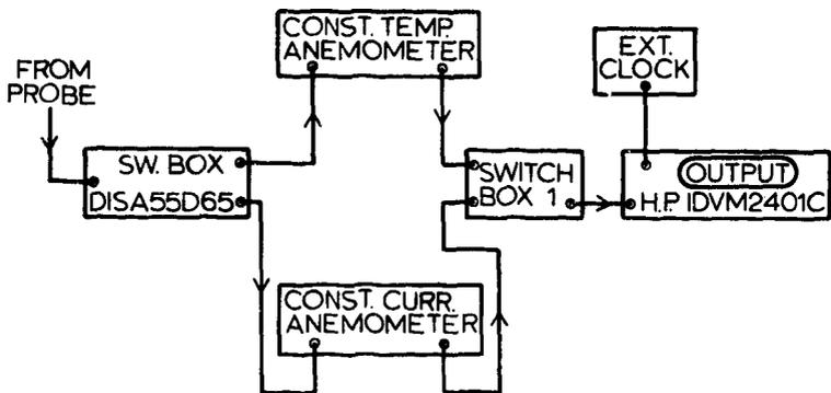
— CIRCUITRY FOR TURBULENCE MEASUREMENTS —
