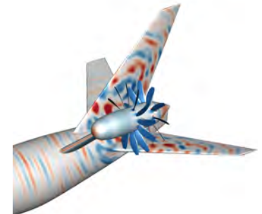
Contra-Rotating Open Rotor, courtesy of Lukas Dürrwächter
