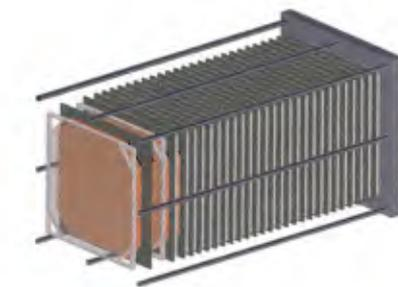
Abbildung 5.1: Prinzipieller Aufbau eines Brennstoffzellenstacks.<sup>(92)</sup>
