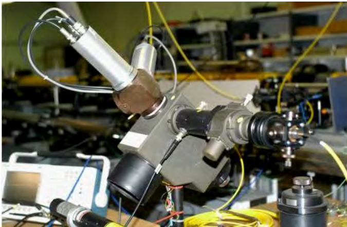
ISL Laser Doppler Velocimeter
