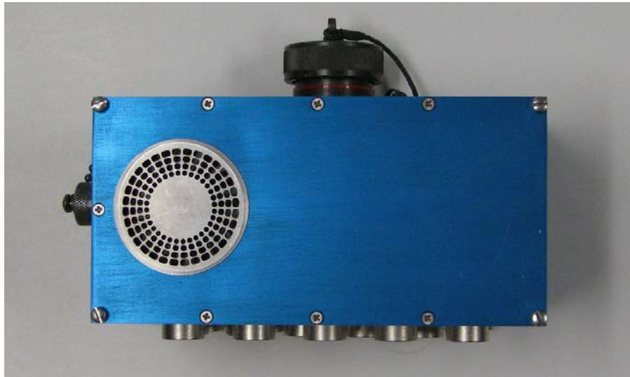
Figure A-5. Fan baffle.
