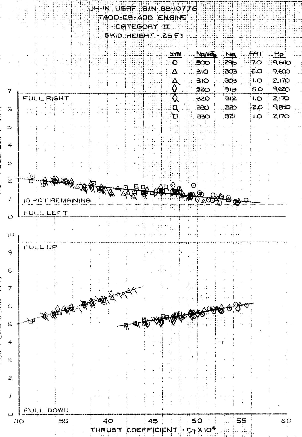
FIGURE 16 FLIGHT CONTROL POSITIONS IN HOVERING FLIGHT
