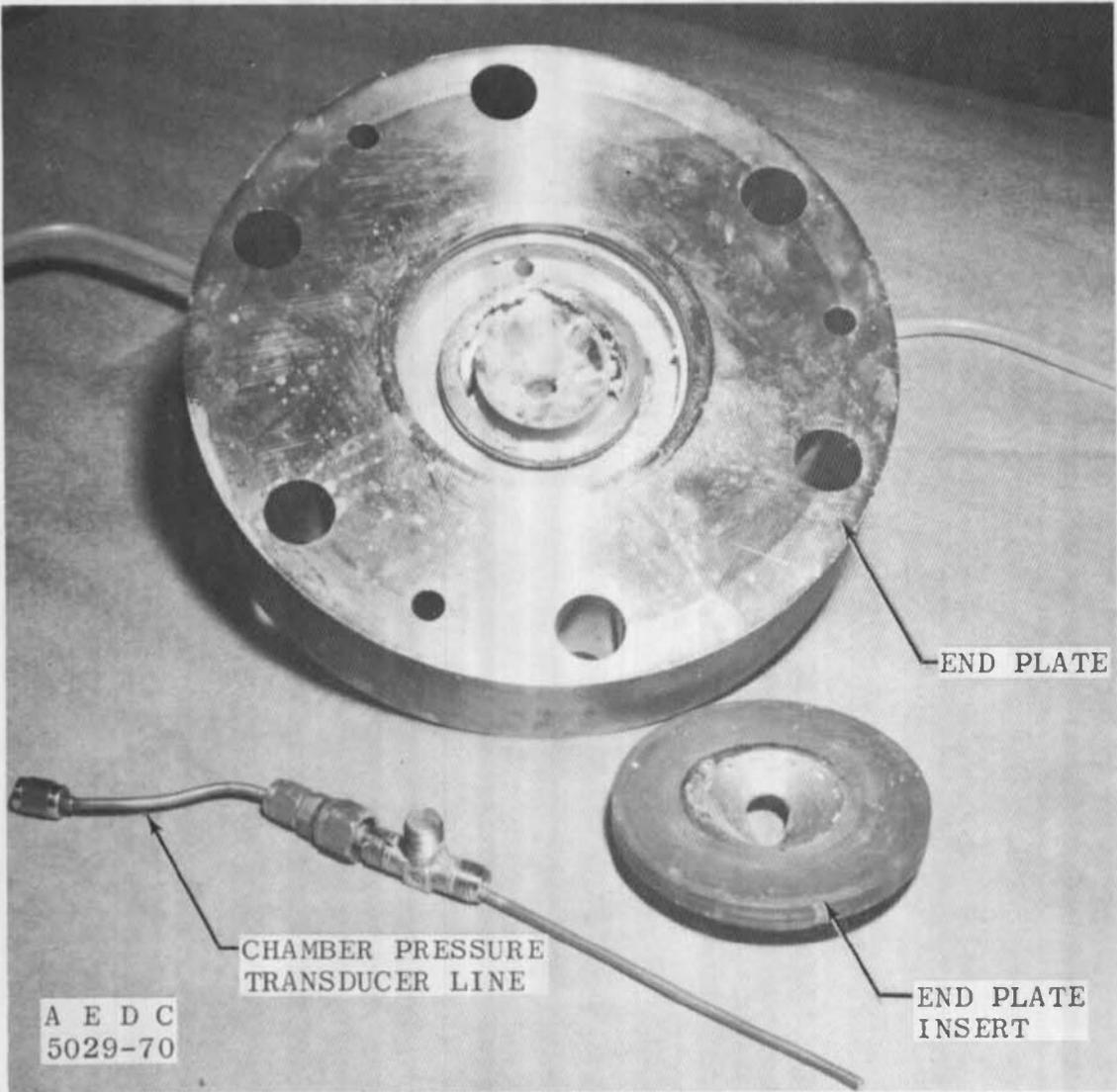
a. End Plate and End Plate Insert
