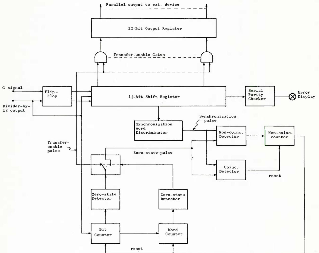
FIG. 19 SIMPLIFIED BLOCK DIAGRAM OF THE WORD SYNCHRONIZER
