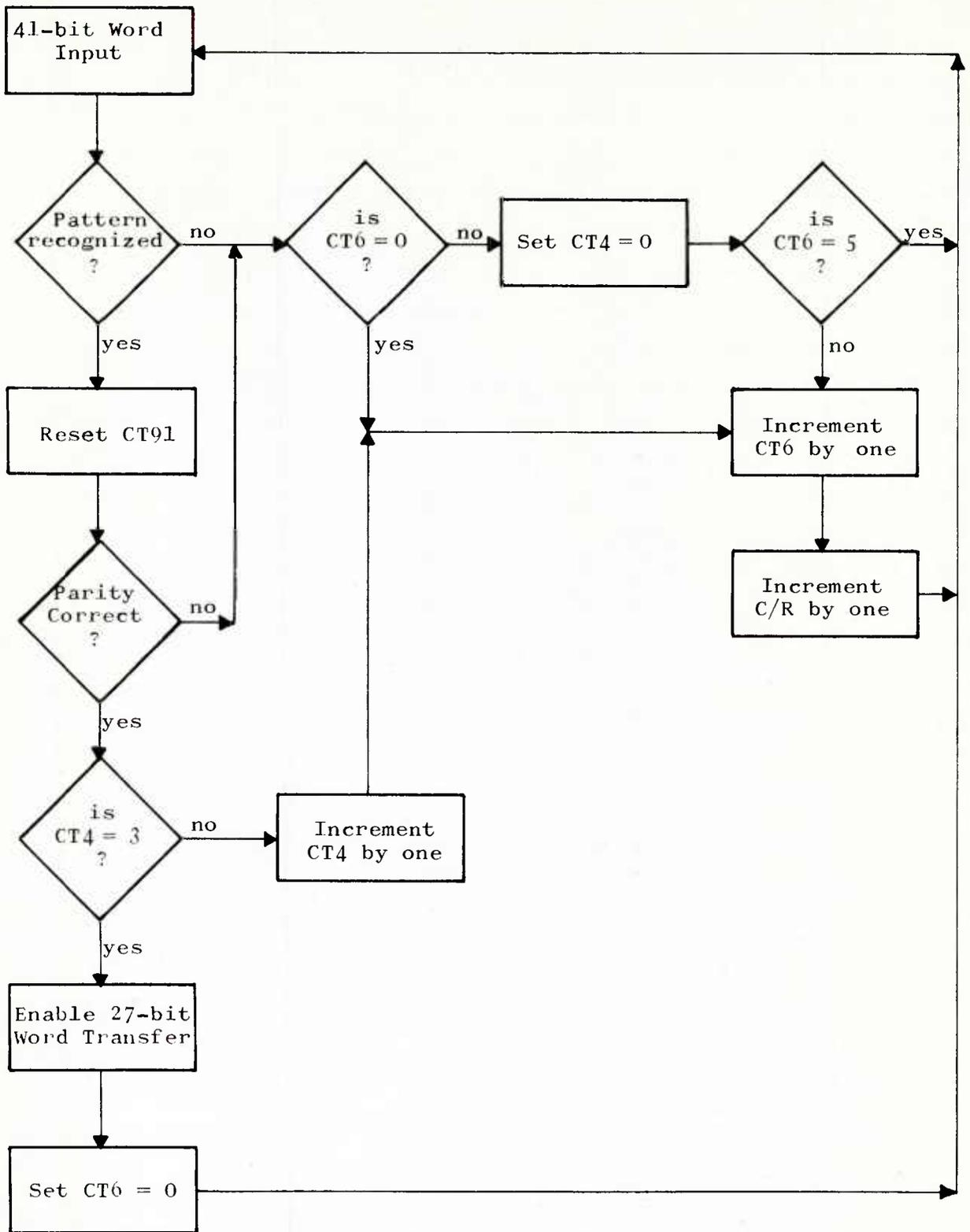
FIG. 22 OPERATION OF COUNTER TRACK READING UNIT
