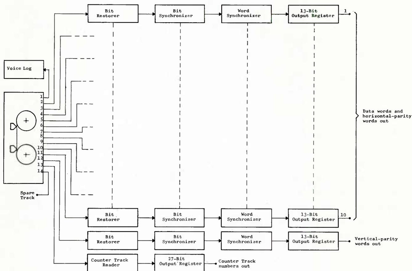
FIG. 2 DIGITAL RECORDING SYSTEM : REPRODUCE SECTION
