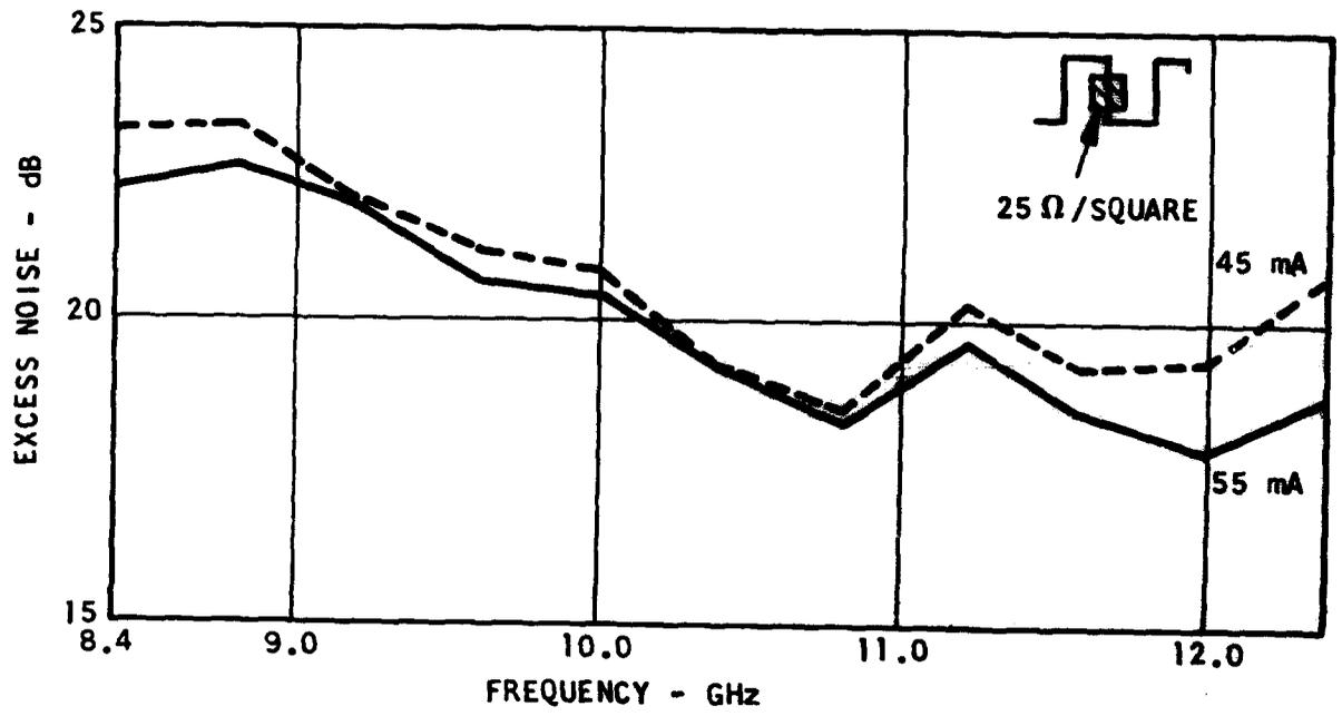
FIGURE 17 NOISE POWER VS FREQUENCY EFFECT OF A 25 Ω/SQUARE LOAD
