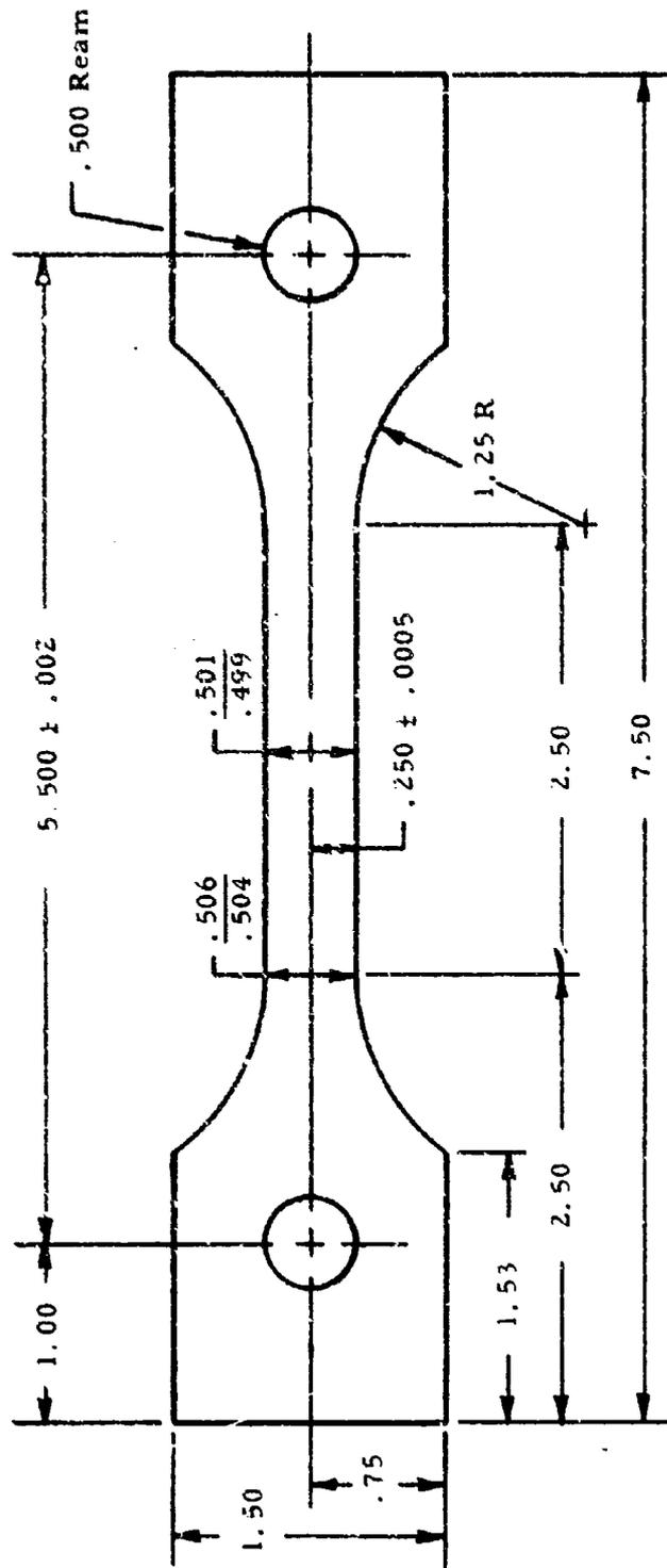
STRESS CORROSION SPECIMEN FOR TITANIUM
