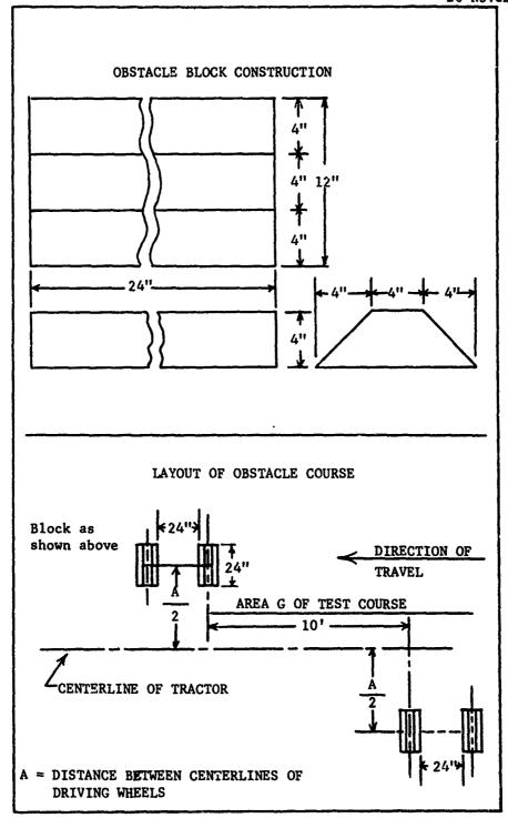
OBSTACLE BLOCK CONSTRUCTION & LAYOUT
