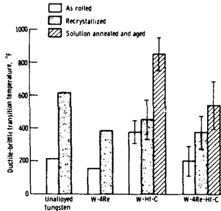
FIGURE 5. DUCTILE-BRITTLE TRANSITION TEMPERATURES FOR ARC-MELTED TUNGSTEN, W-4Re, W-Hf-C<sup>(10)</sup>
