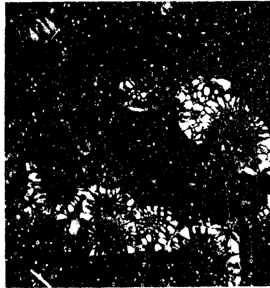
(d) Rene' 100 (Less V) + 0.11 W/O Gd + 0.2 W/O Mn - Note Increase \gamma - \gamma' Eutectic
