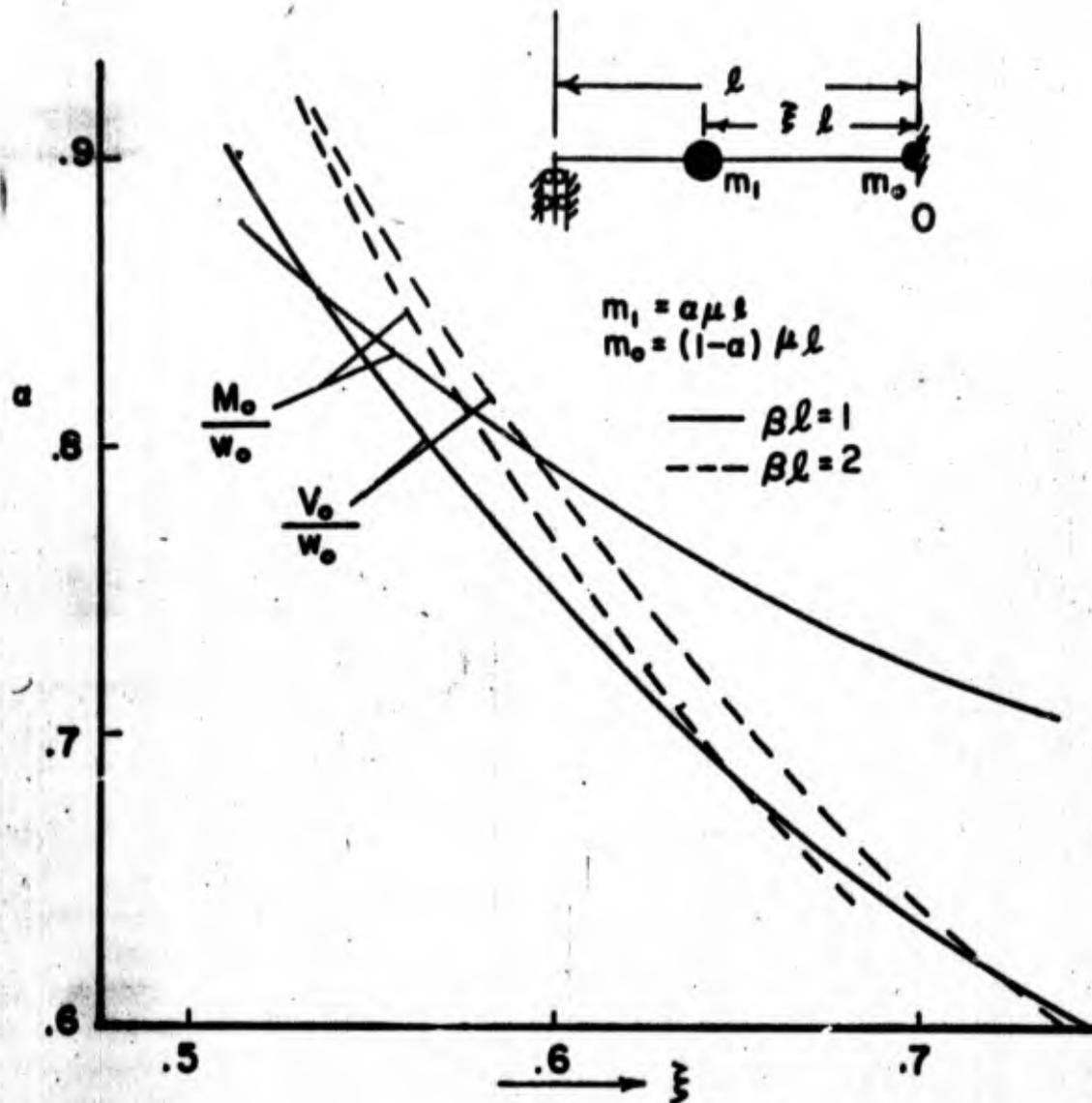
FIG. A-6 OPTIMIZING CONDITION FOR CLAMPED-GUIDED BEAM
