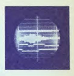
Photo. 8 3-Forward-Pulse Train 3-Reverse-Pulse Train 13.7 p.p.s., 50 millisec/cm
