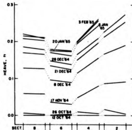
Figure 27. Longitudinal heave profiles, 1964-65.
