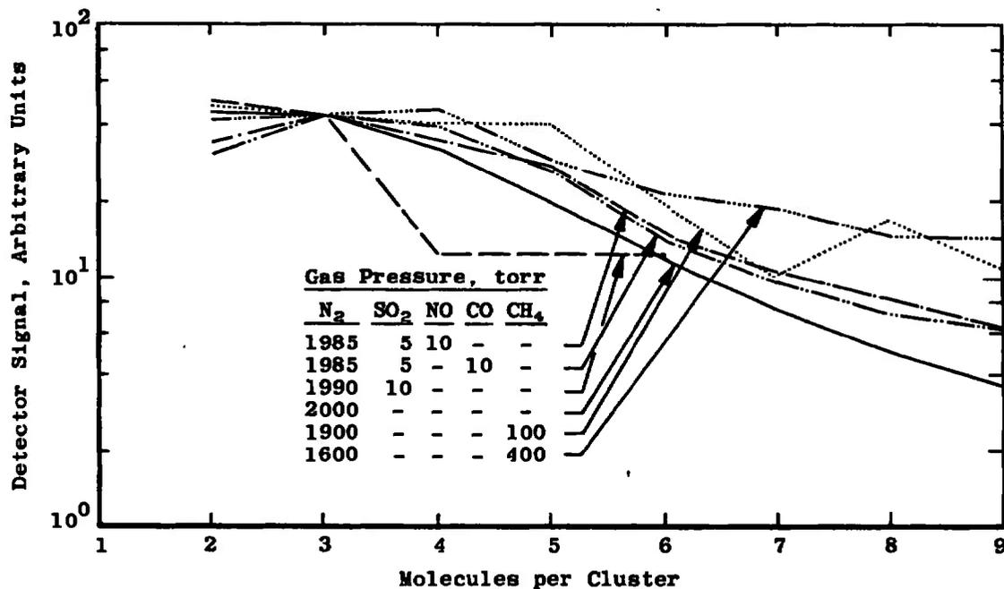
a. H<sub>2</sub>O/N<sub>2</sub>/SO<sub>2</sub>/NO/CO/CH<sub>4</sub> mixtures
