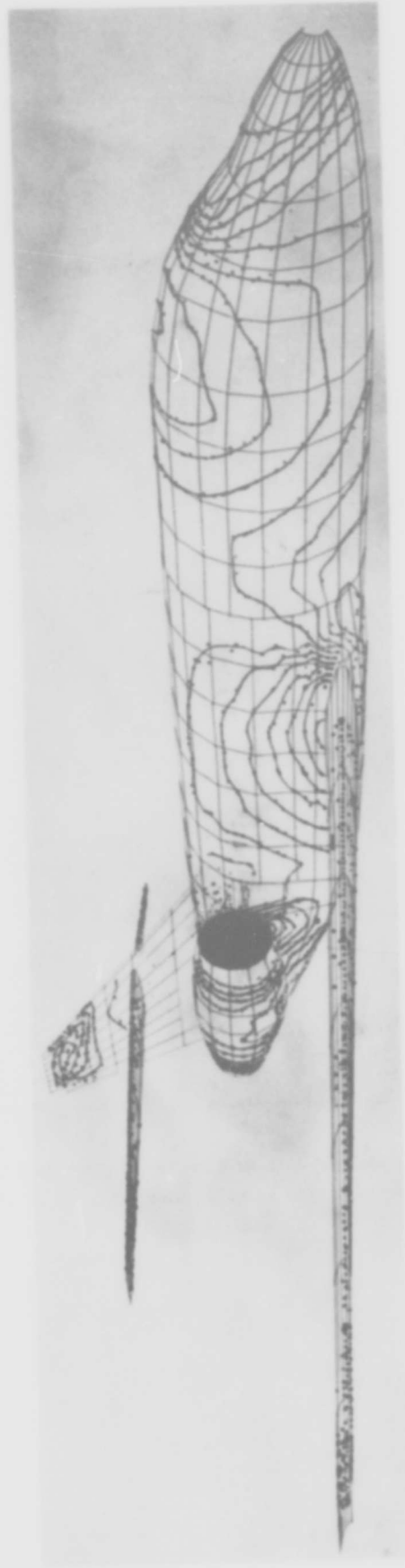
FIGURE 46 : Répartition de pression sur avion complet. Pressure distribution on complete aircraft.
