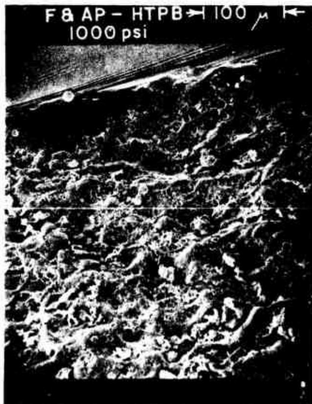
Figure III-40. HTPB-AP and Ferrocene (F) 1000 psia (x221).
