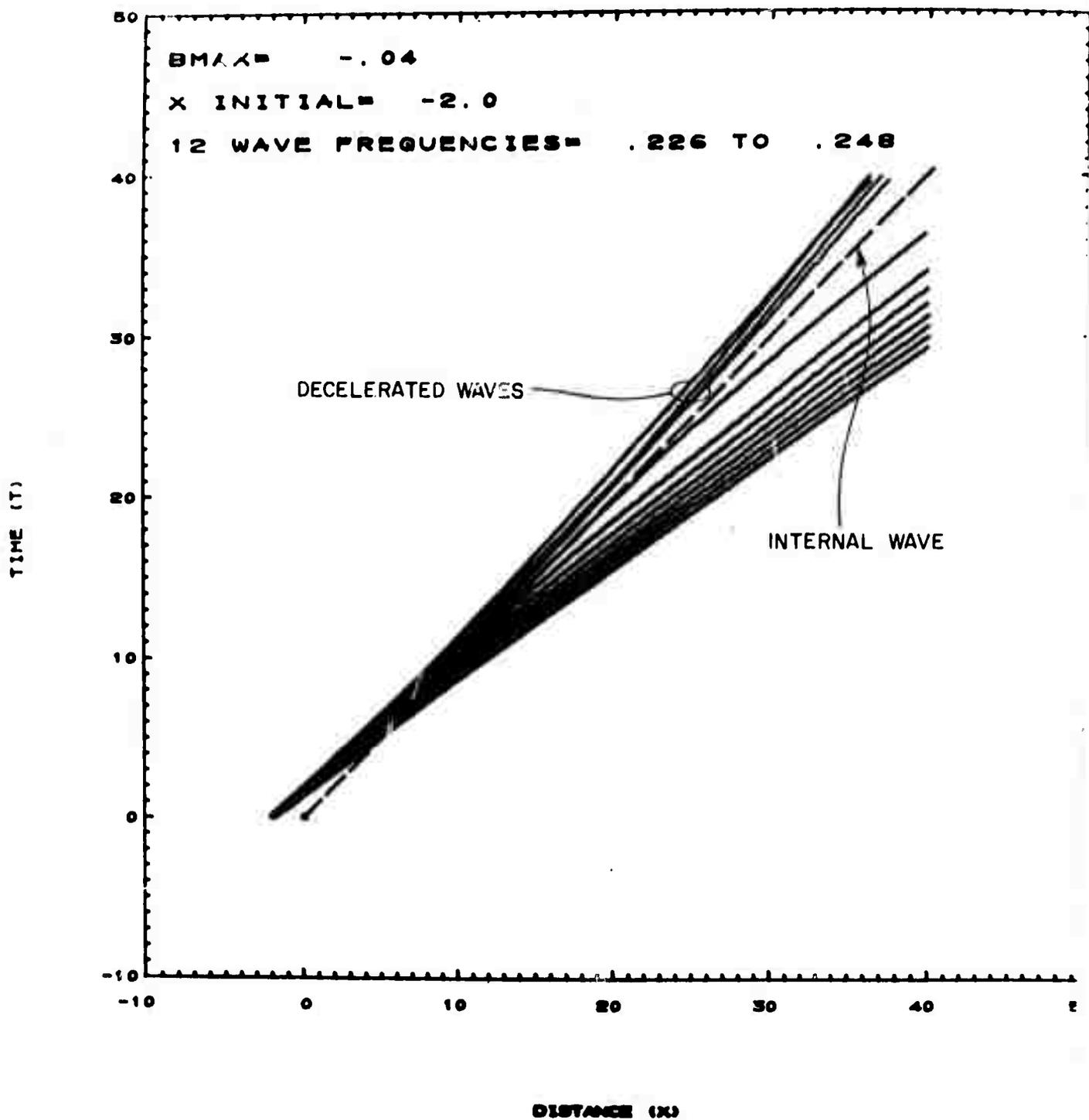
FIGURE 12A. SPACE-TIME TRAJECTORIES FOR THE STRONGLY INTERACTING GRAVITY WAVES ( $\phi(+)$  WAVES)
