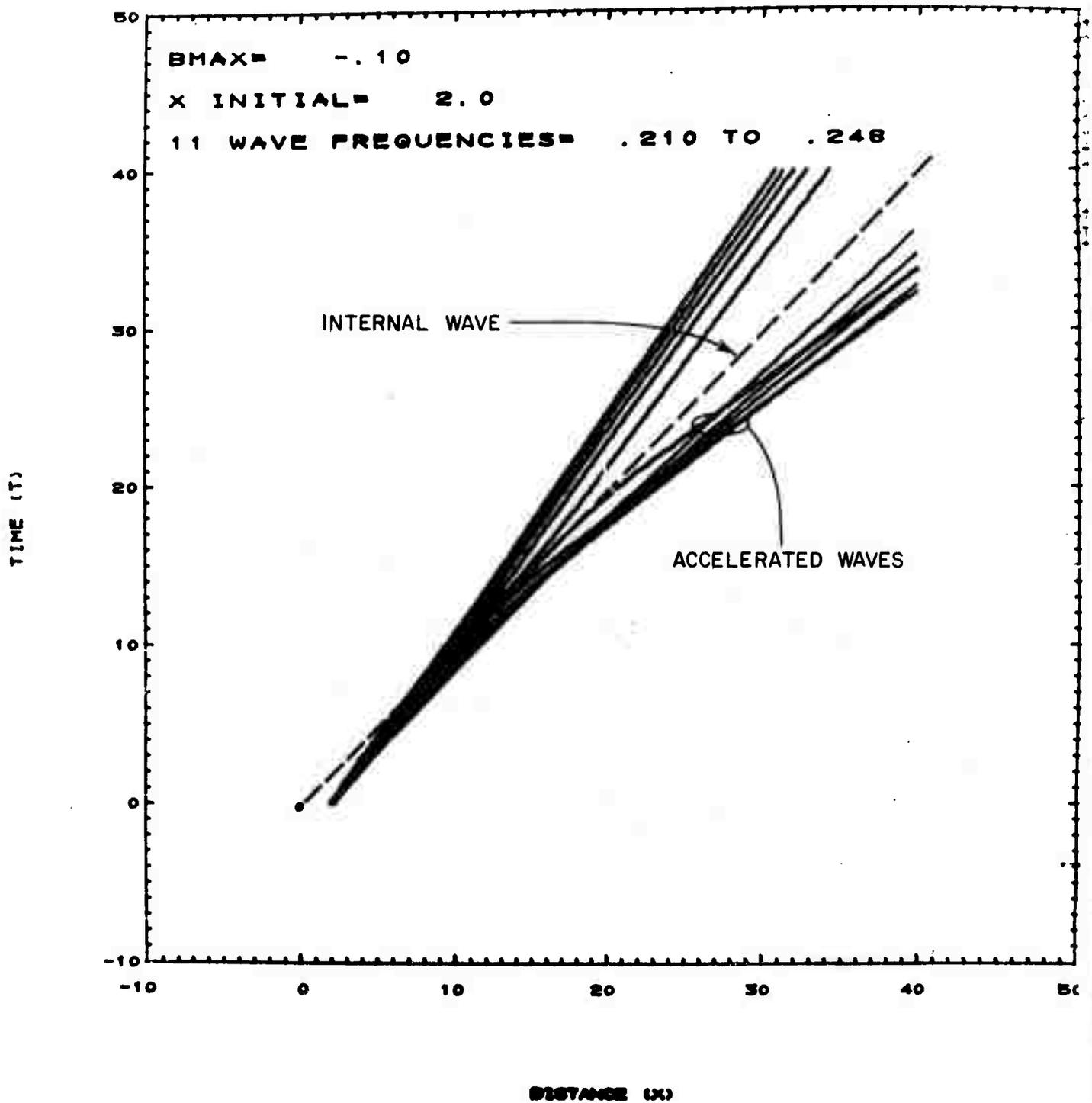
FIGURE 12D. SPACE-TIME TRAJECTORIES FOR THE STRONGLY INTERACTING GRAVITY WAVES ( $\phi^{(-)}$  WAVES)
