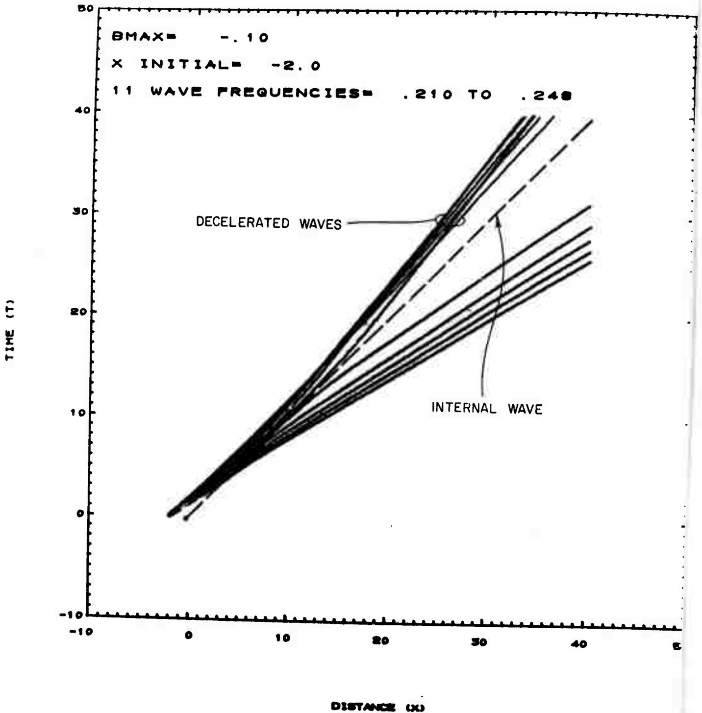
FIGURE 12C. SPACE-TIME TRAJECTORIES FOR THE STRONGLY INTERACTING GRAVITY WAVES ( $\phi^{(+)}$  WAVES)
