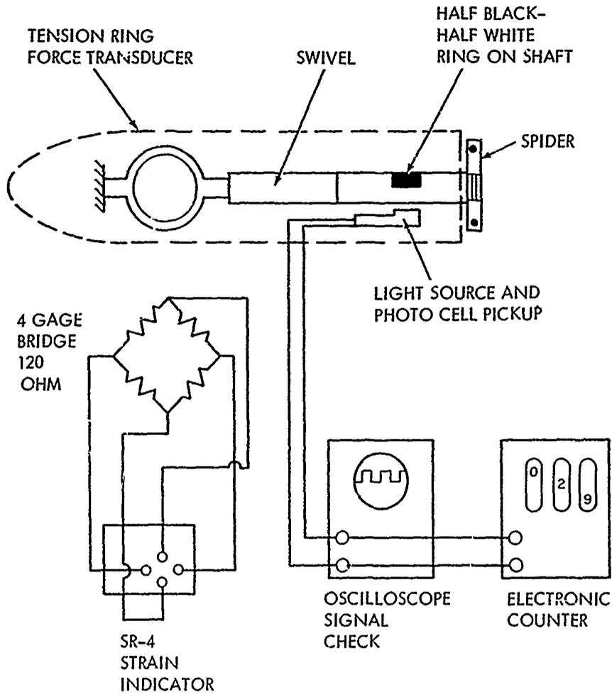
FIG. 4 SCHEMATIC OF TEST INSTRUMENTATION
