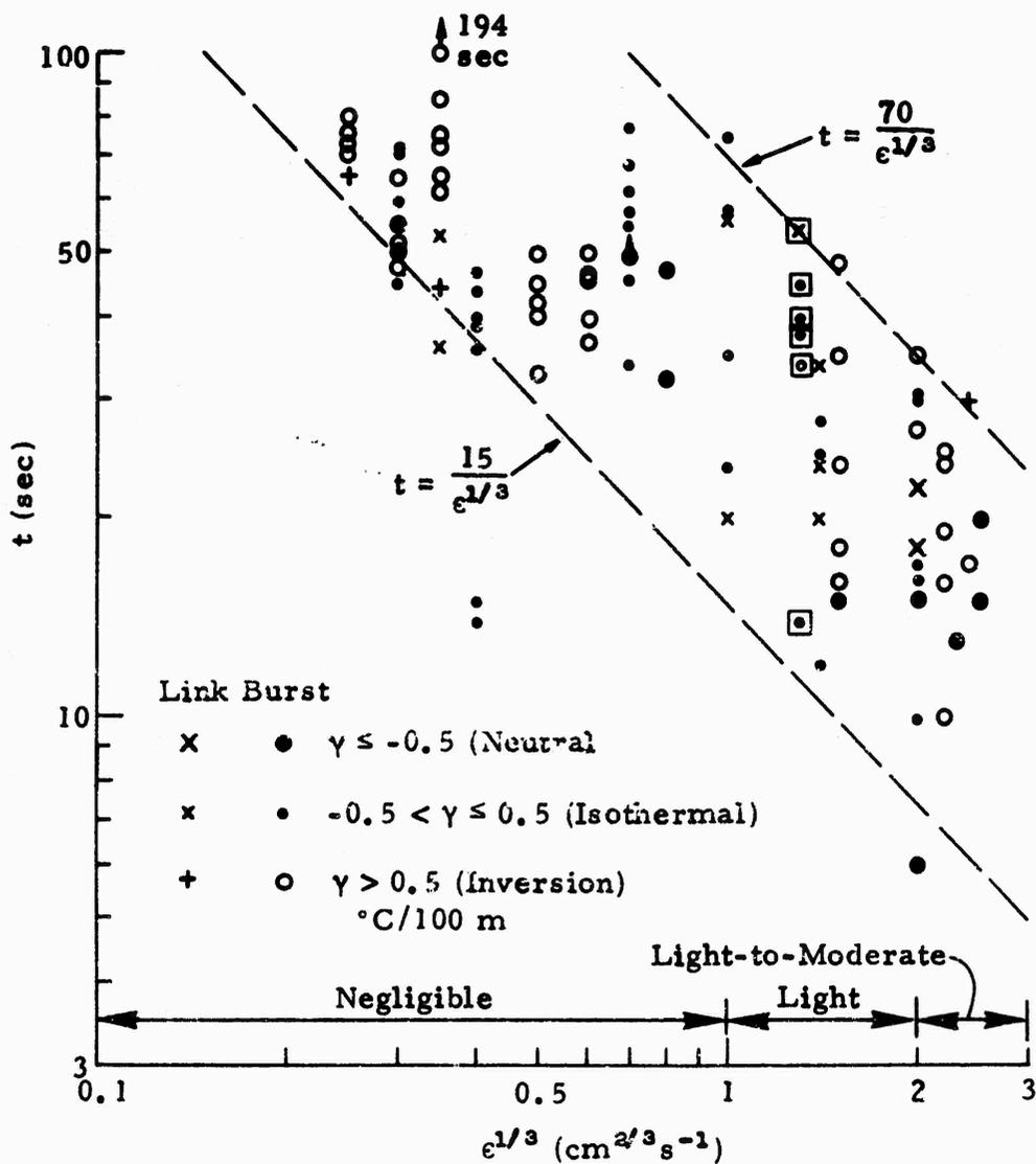
Fig. 24. TIME OF OCCURRENCE OBSERVED INSTABILITIES AS A FUNCTION OF TURBULENCE
