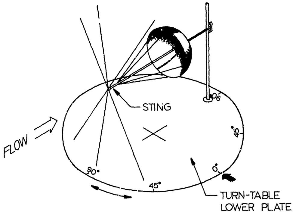
FIG 3. MODEL SUSPENSION
