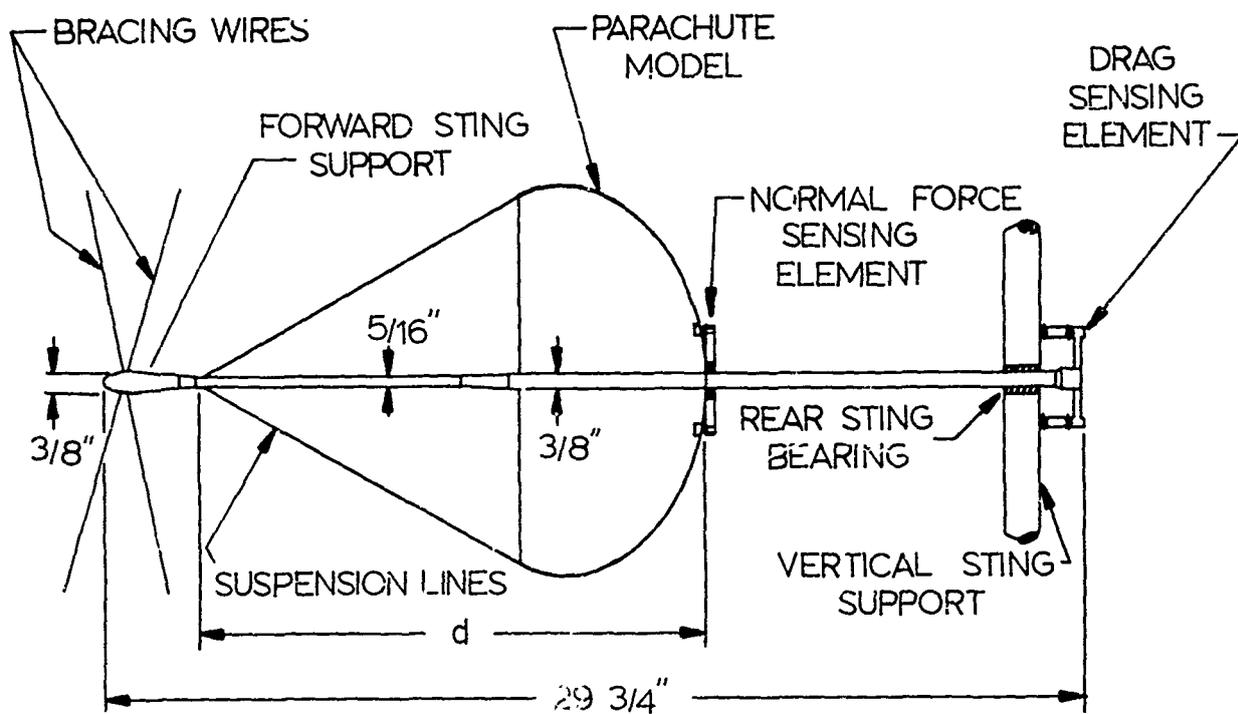
FIG 4. MODEL SUSPENSION AND STRAIN GAGE BALANCE ARRANGEMENT<sub>8</sub>
