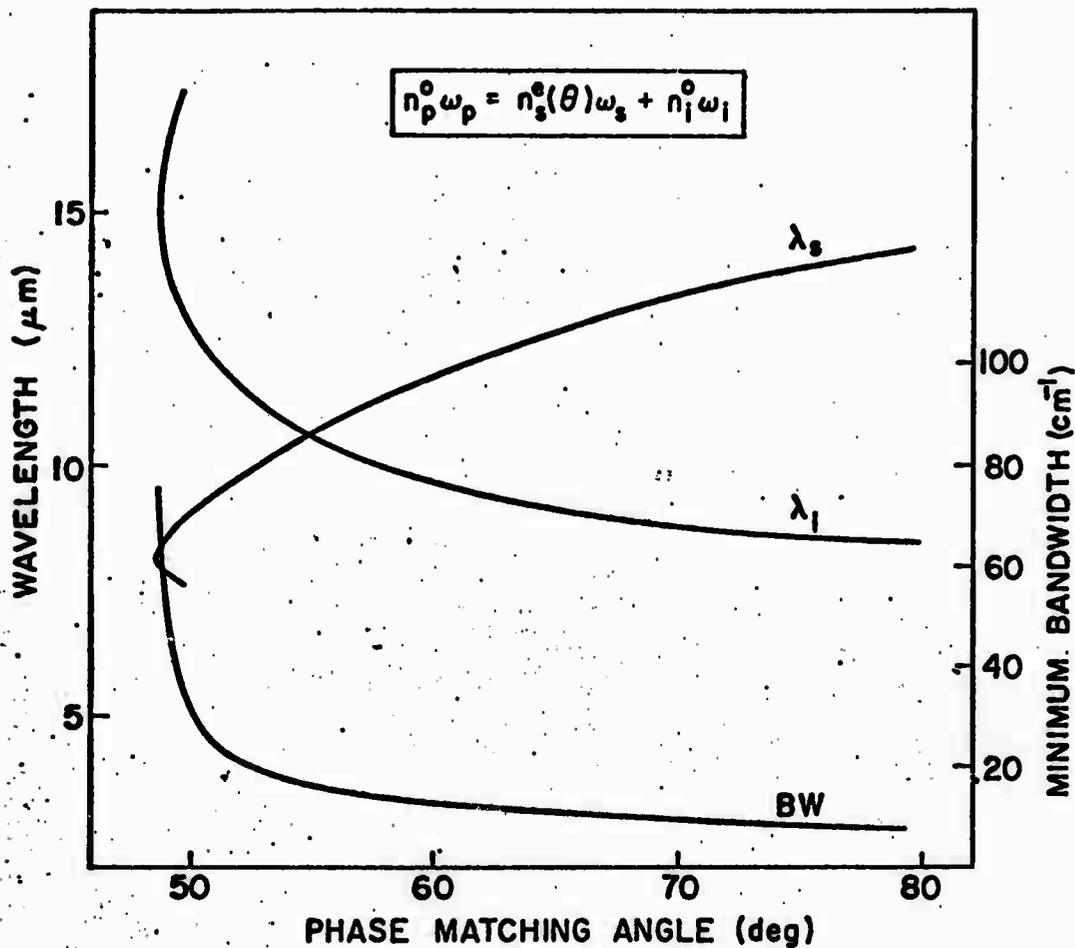
Fig. 8--THEORETICAL TUNING CURVE AND MINIMUM BANDWIDTH FOR A ONE cm CdGeAs<sub>2</sub> CRYSTAL PUMPED BY A PUMP WAVELENGTH OF 5.3 $\mu\text{m}$ .
