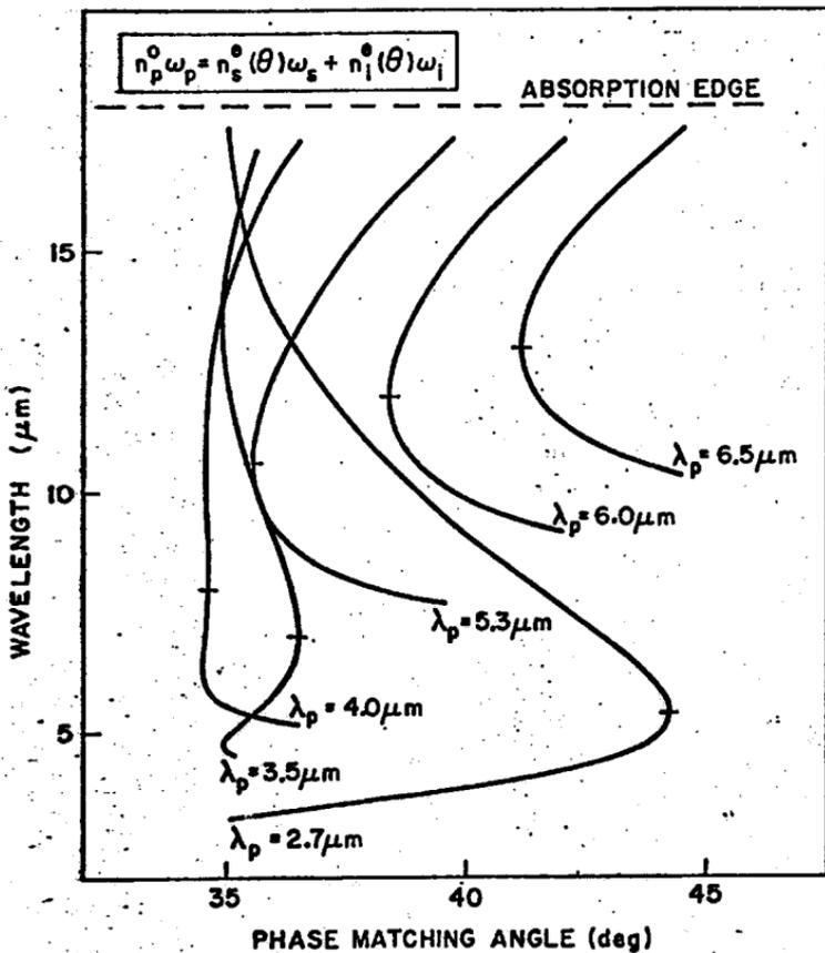
Fig. 5—THEORETICAL TUNING CURVES FOR SEVERAL PUMP WAVELENGTHS IN CdGeAs<sub>2</sub>
