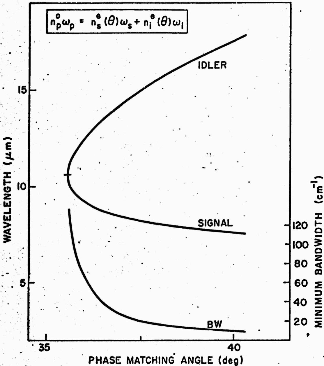
Fig. 9--THEORETICAL TUNING CURVE AND MINIMUM BANDWIDTH FOR A ONE cm CdGeAs<sub>2</sub> CRYSTAL PUMPED BY A PUMP WAVELENGTH OF 5.3 $\mu\text{m}$
