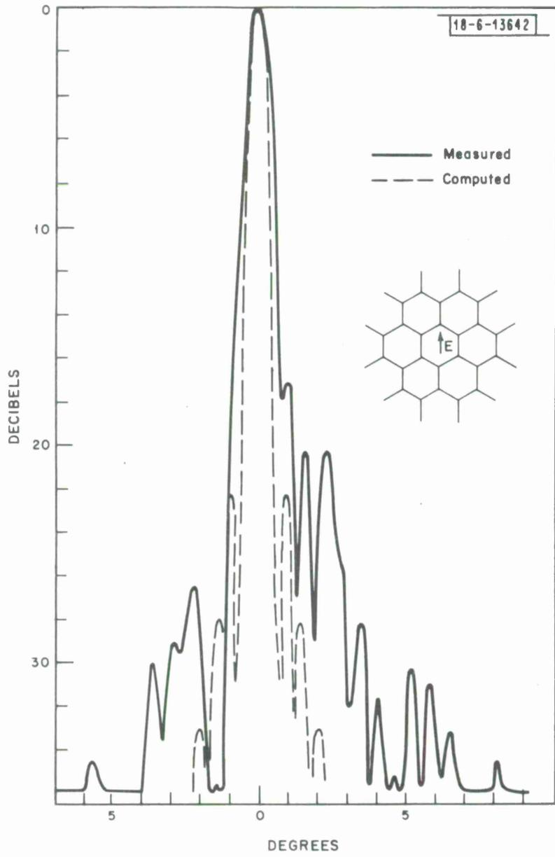
Fig. 8. H-plane pattern of EHF lens antenna.
