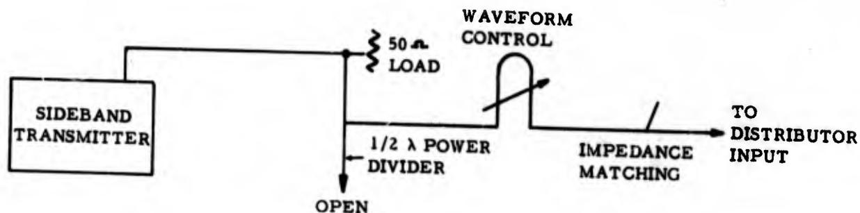
Figure 11. METHOD OF ISOLATION OF THE SIDEBAND TRANSMITTER FROM THE VARYING LOAD IMPEDANCE OF THE DISTRIBUTOR
