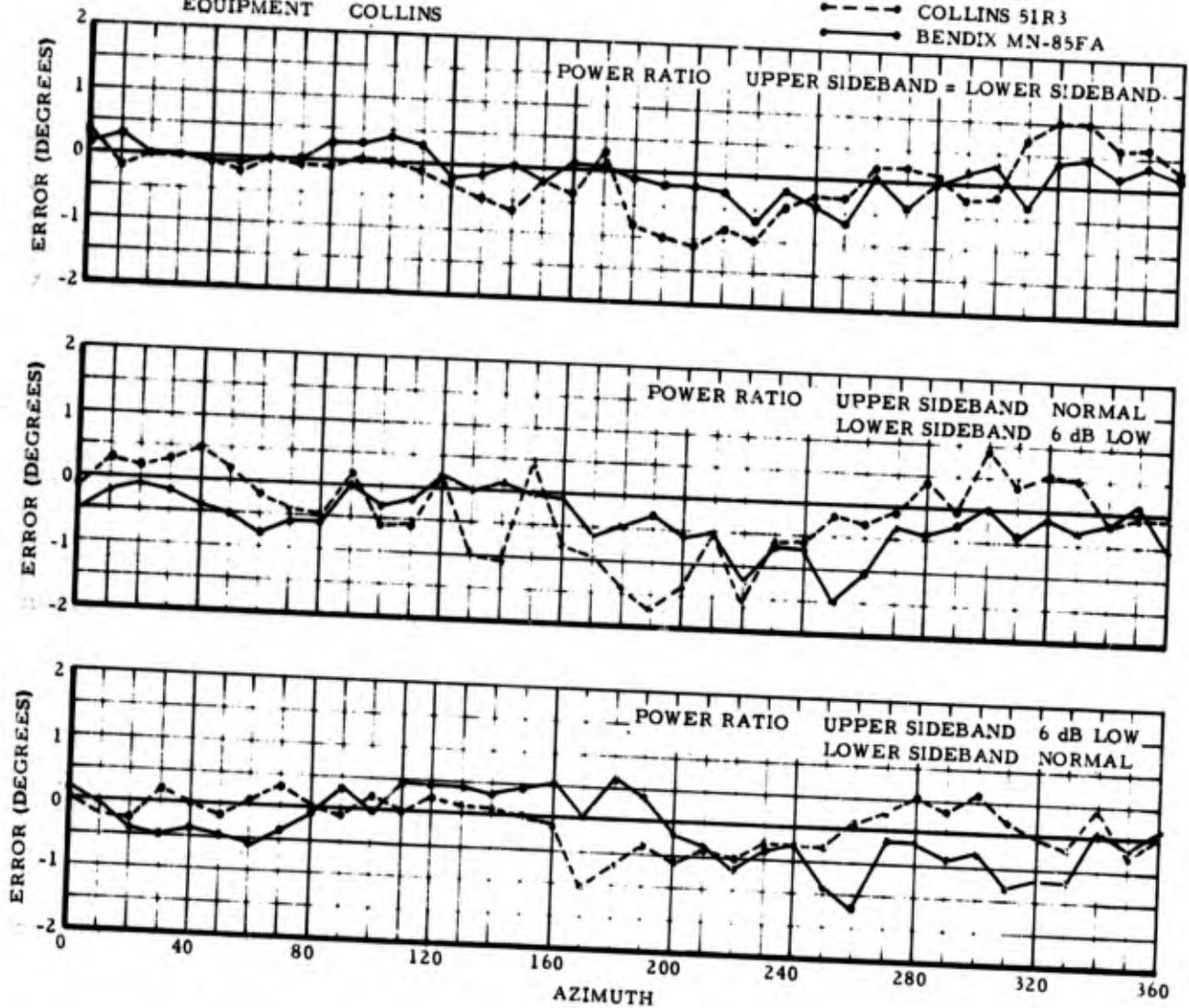
Figure 18. INDICATED SYSTEM ERROR AS A FUNCTION OF SIDE BAND POWER RATIO
