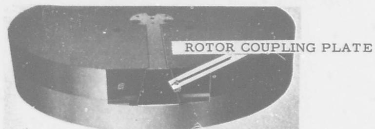
Figure 7. DISTRIBUTOR ROTOR
