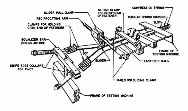
FIGURE 2: ENDURANCE TESTING MACHINE FOR SLIDE FASTENERS
