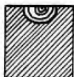
(d) BEND SQUARE BAR - SURFACE CRACK.
