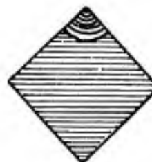
(e) BEND SQUARE BAR - EDGE CRACK (proposal).
