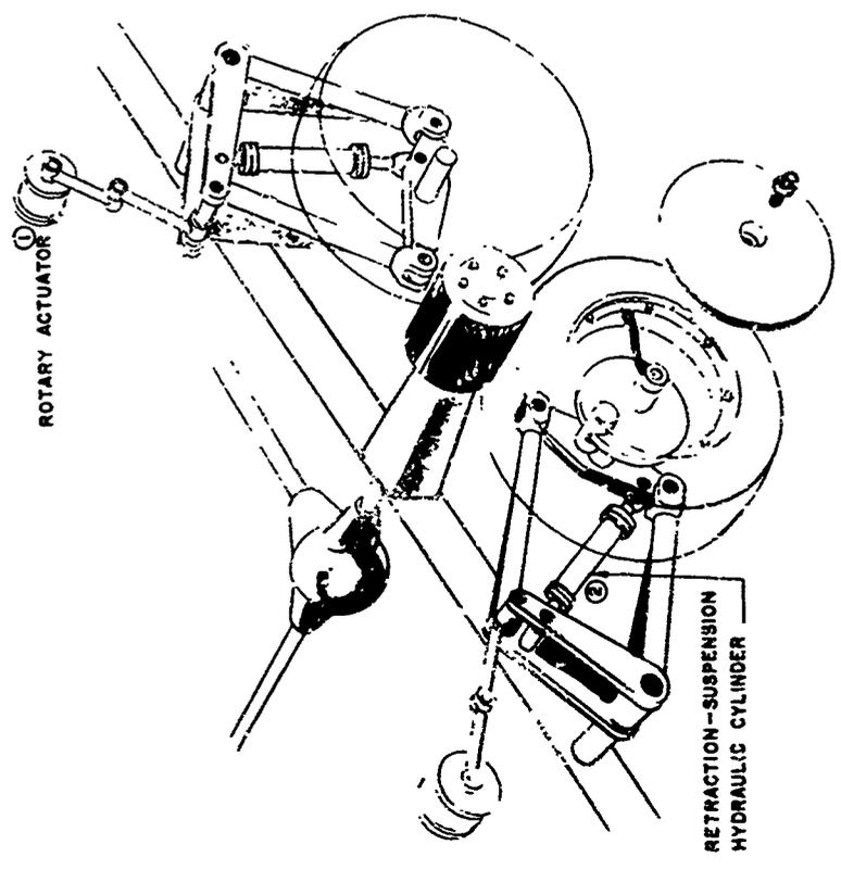
FIG. 42. CONCEPT NO. 1 - ROLLER DRIVE AND WHEEL RETRACTION SYSTEM
