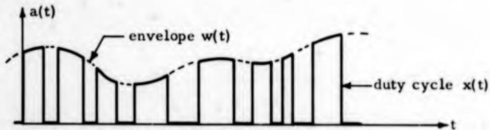
a. Amplitude-Modulated Waveform
