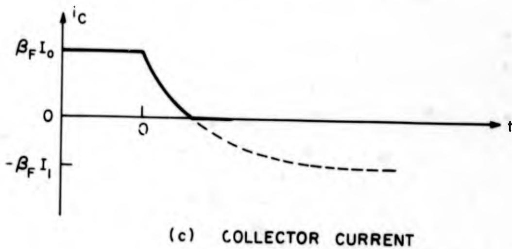
FIG. 3.44 WAVEFORMS FOR FORCED TURN-OFF
