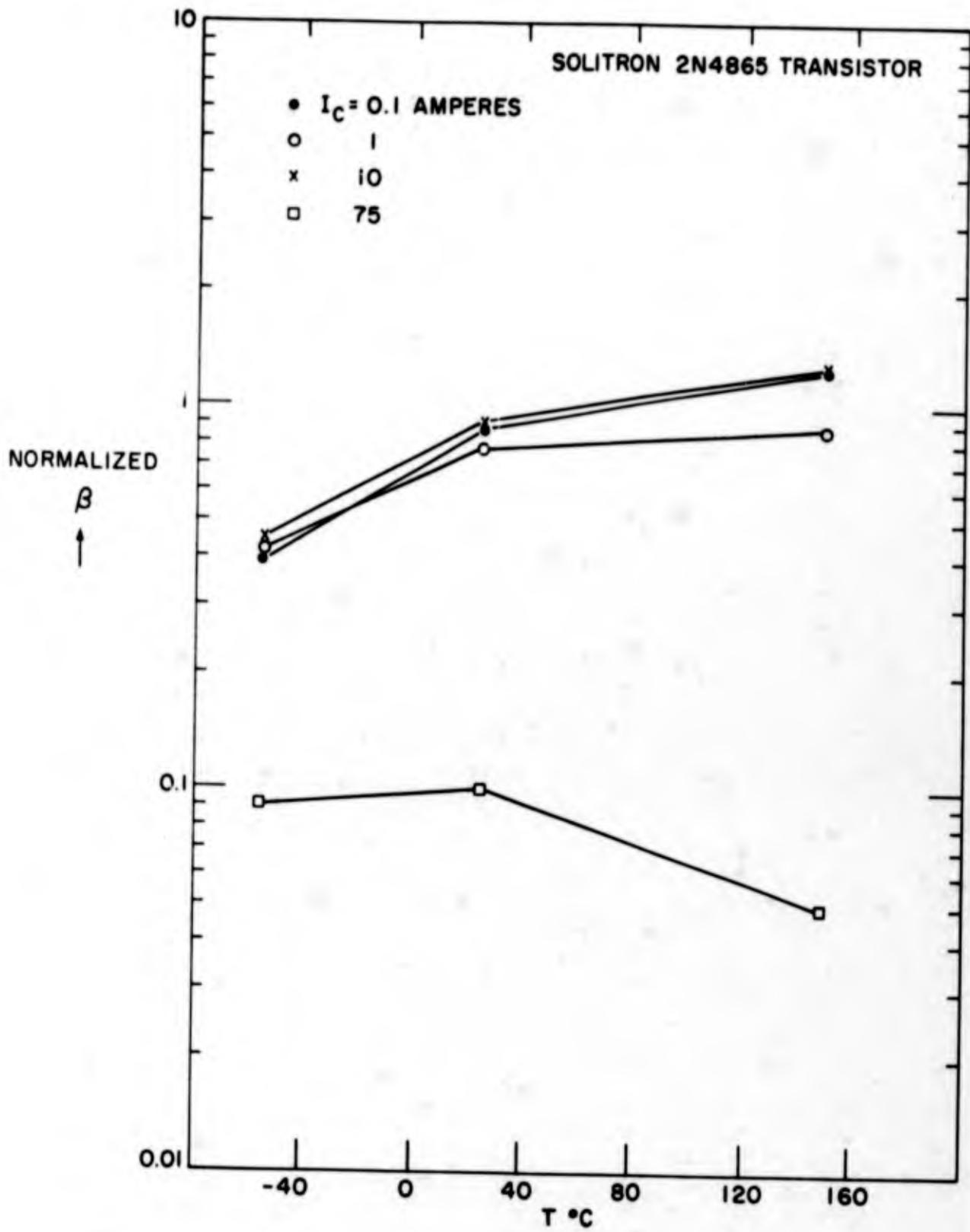
FIG.3.38 PLOT OF  $\beta$  VERSUS TEMPERATURE FOR A SILICON POWER TRANSISTOR.
