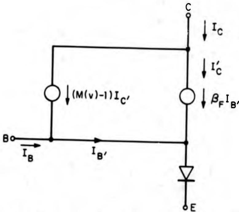
FIG.3.50 BASE CURRENT CONTROLLED AVALANCHE BREAKDOWN MODEL
