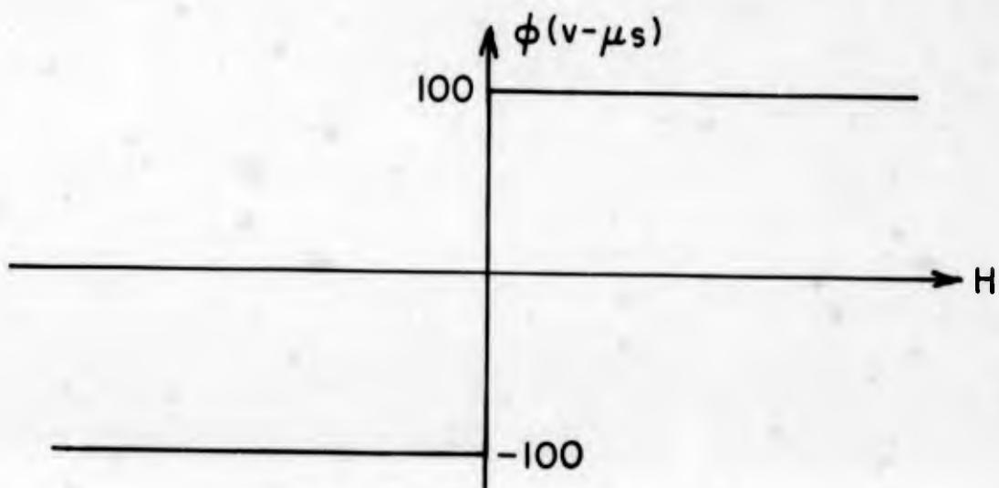
FIGURE 12.34 MODEL OF MAGNETIC AMPLIFIER
