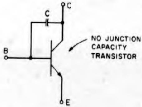
FIG. 3.48a TRANSISTOR MODEL FOR COLLECTOR JUNCTION CAPACITY
