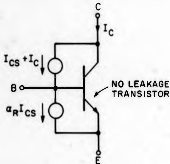
FIG.3.34 COLLECTOR LEAKAGE MODEL
