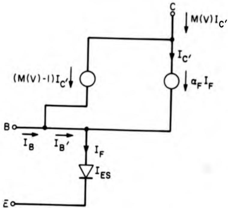
FIG.3.49 BASIC AVALANCHE BREAKDOWN TRANSISTOR MODEL
