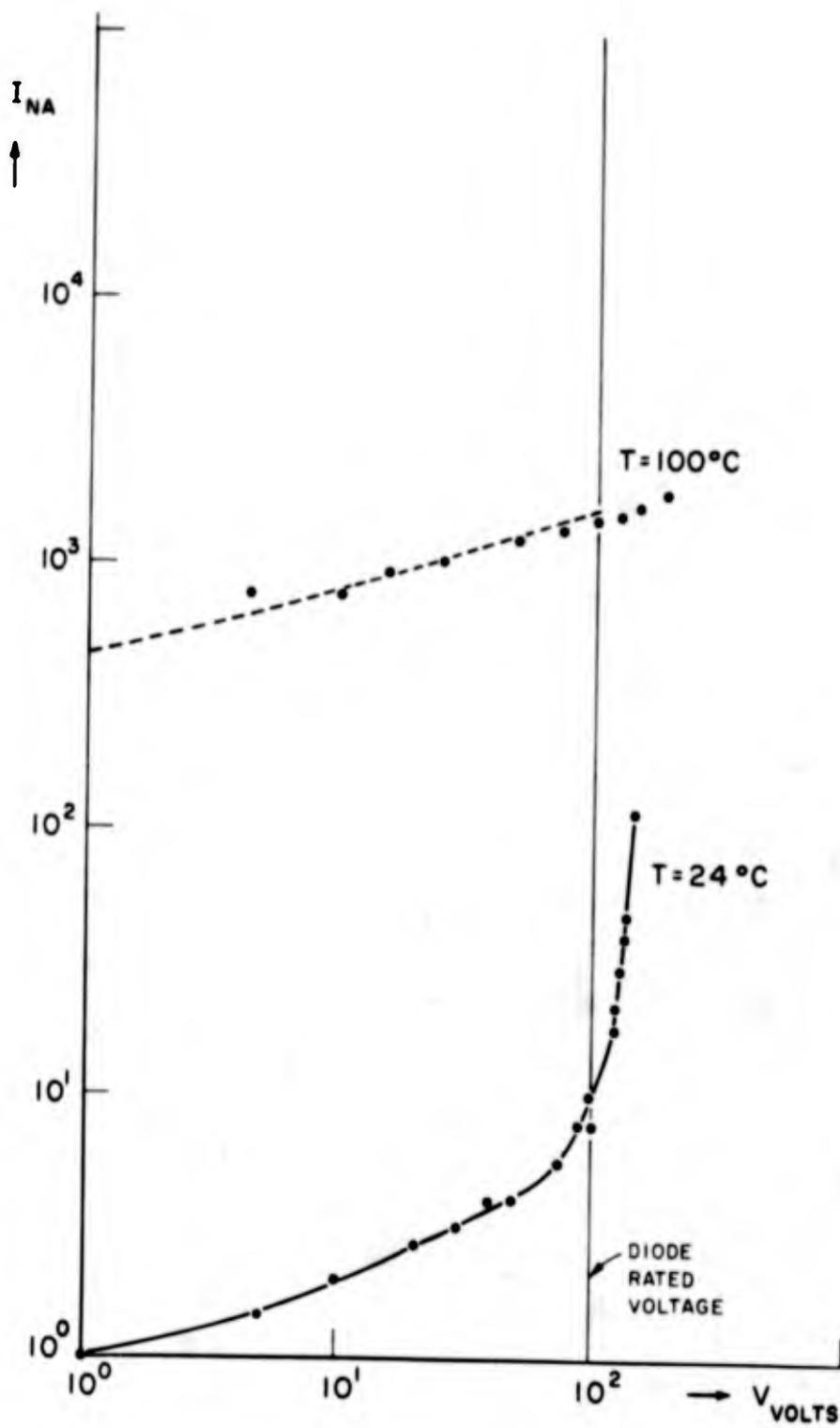
FIG. 3.7 REVERSE VOLT-AMPERE CHARACTERISTICS OF A SILICON POWER DIODE.
