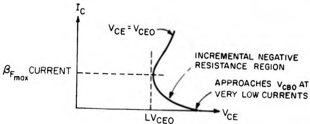
FIG. 3.51  $V_{CEO}$  VERSUS COLLECTOR CURRENT
