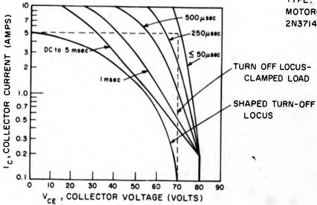
FIG.3.52 TYPICAL SAFE OPERATING AREA DATA FOR A SILICON POWER TRANSISTOR
