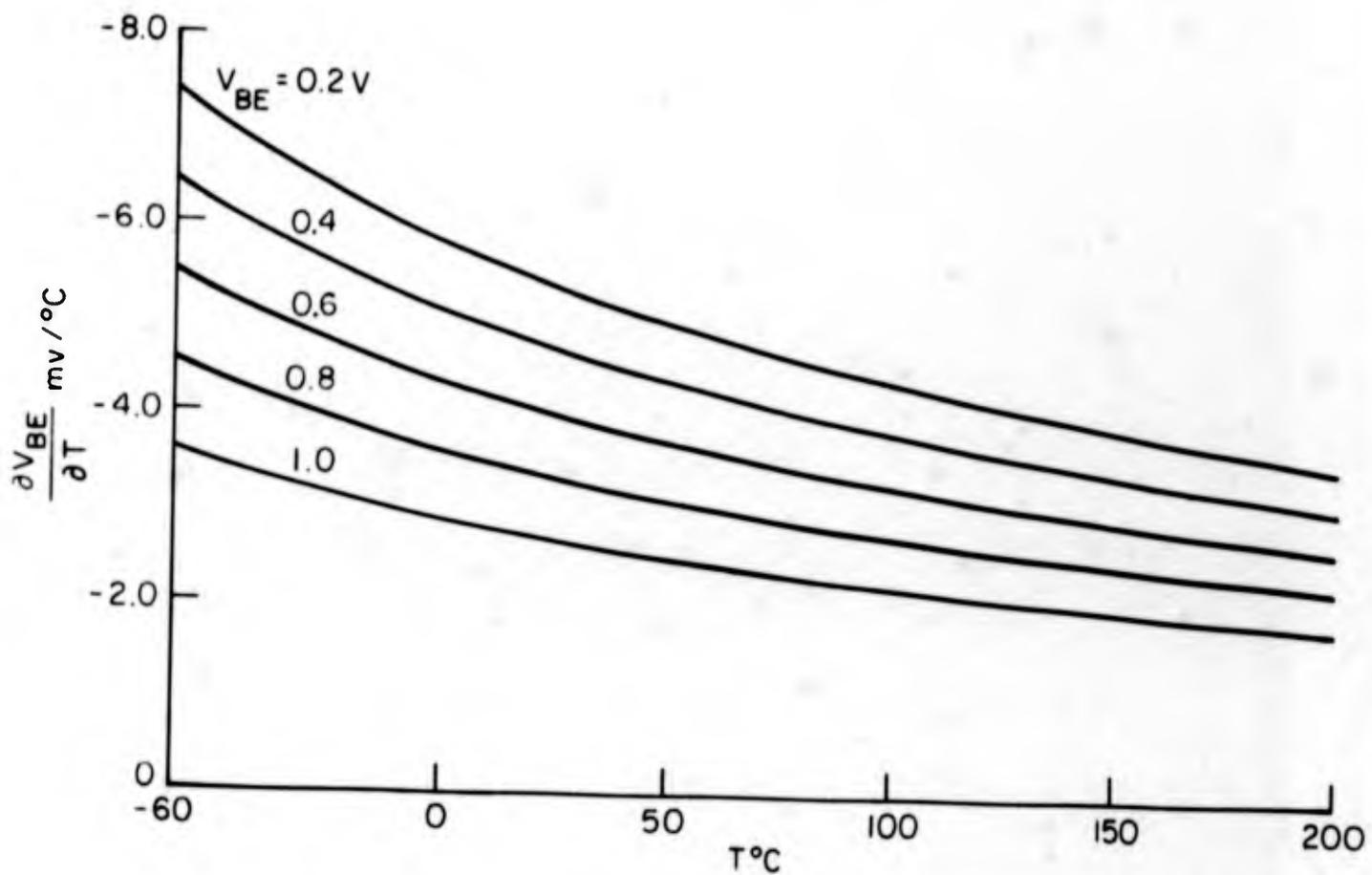
FIG.3.40 BASE-EMITTER TEMPERATURE COEFFICIENT FOR A SILICON TRANSISTOR.
