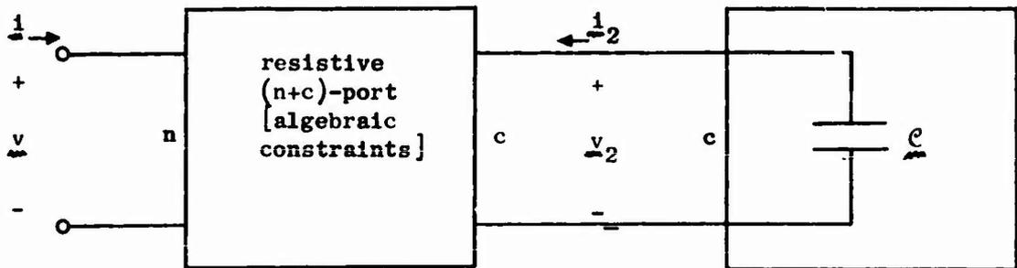
Fig. II-2. CAPACITOR EXTRACTION.
