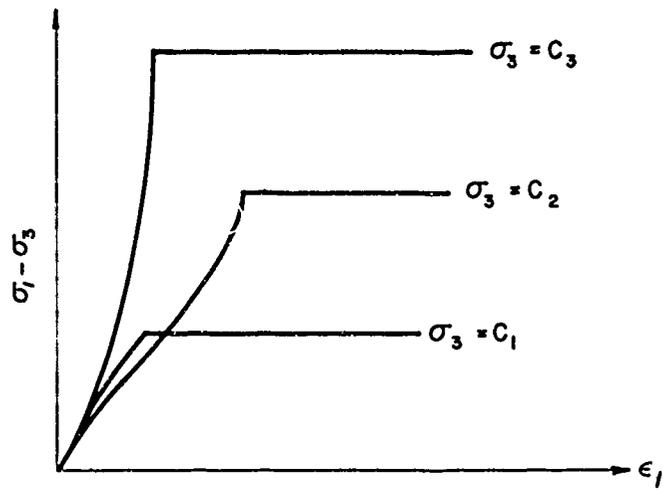
FIG. 10 TRIAXIAL COMPRESSION TEST
